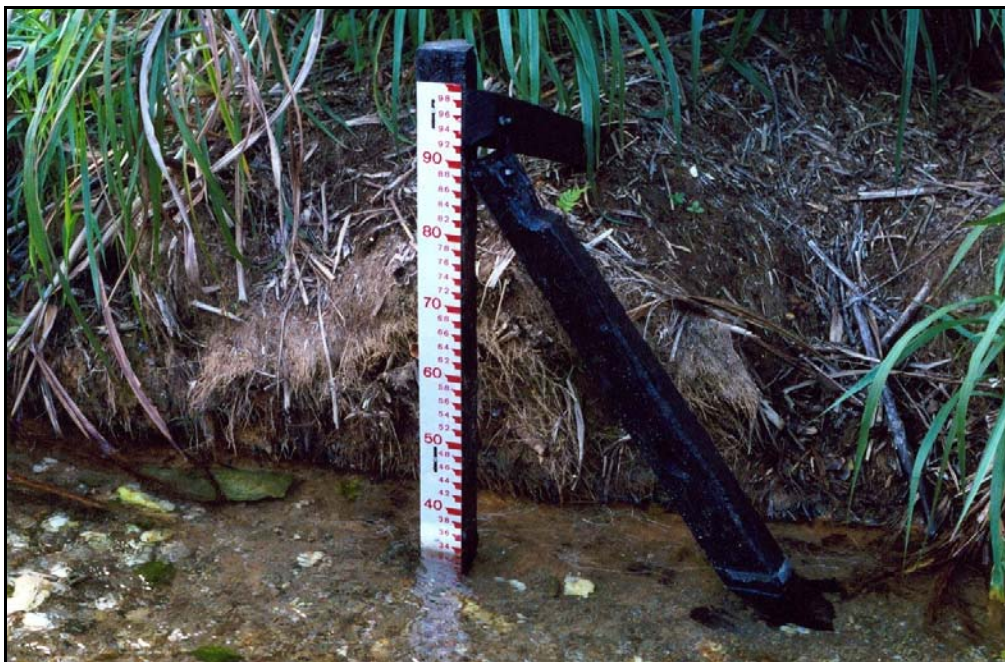
Figura 9.1 - Règua linimétrica instalada na surgência do Tadinho.
