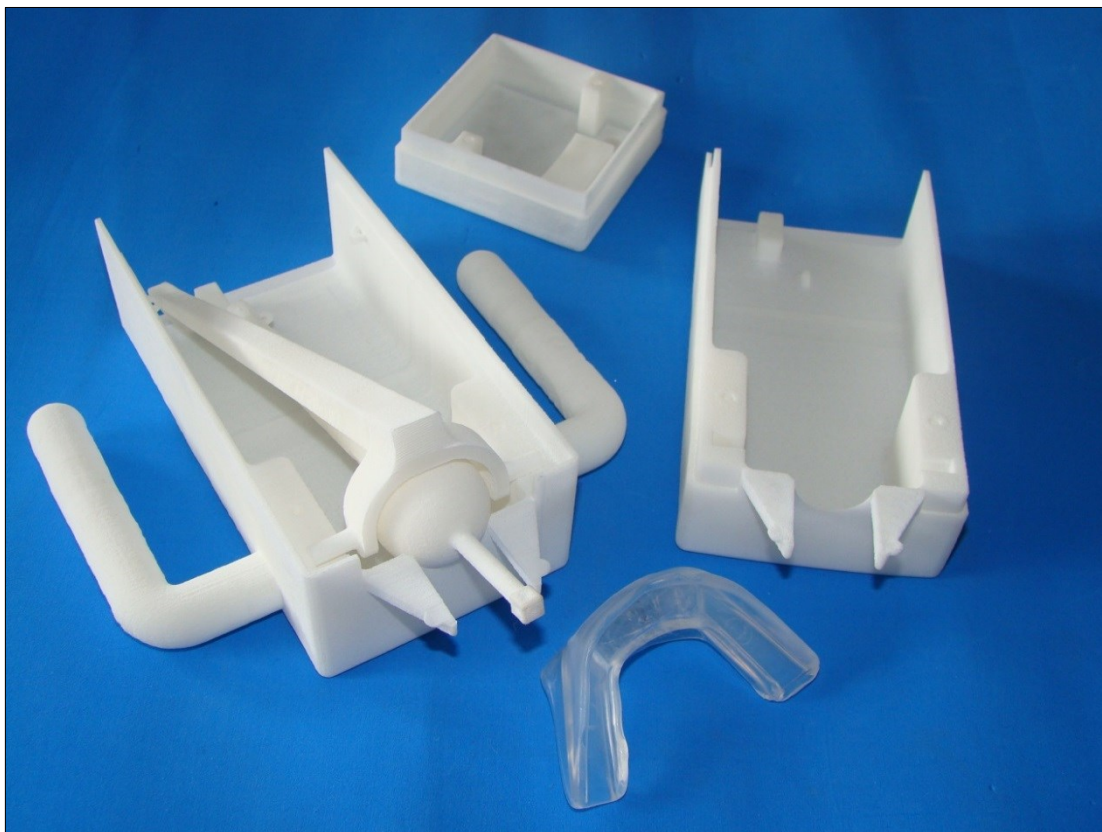
Figura 37 - Primeira versão do protótipo confeccionada pelo método de sinterização seletiva a laser
