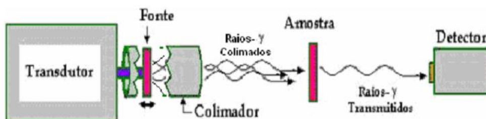
Figura 3.12 - Arranjo experimental simplificado da espectroscopia Mössbauer, na geometria de transmissão. Fonte: Biondo, 2005.
