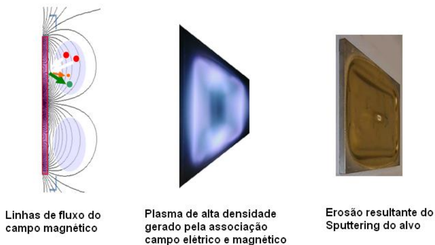
Figura 2-9 Região de concentração do plasma e corrosão do alvo planar por Magnetron Sputtering
