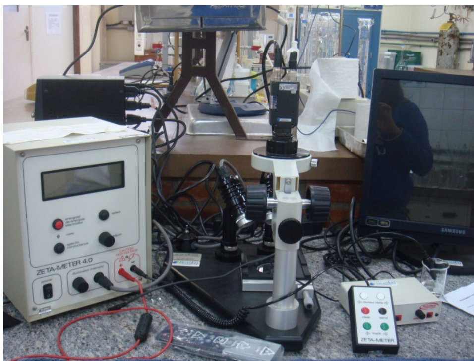
Figura 3.24: Zeta Meter 4.0 usado na aquisição das medidas eletrocinéticas (Universidade Federal de Ouro Preto).
