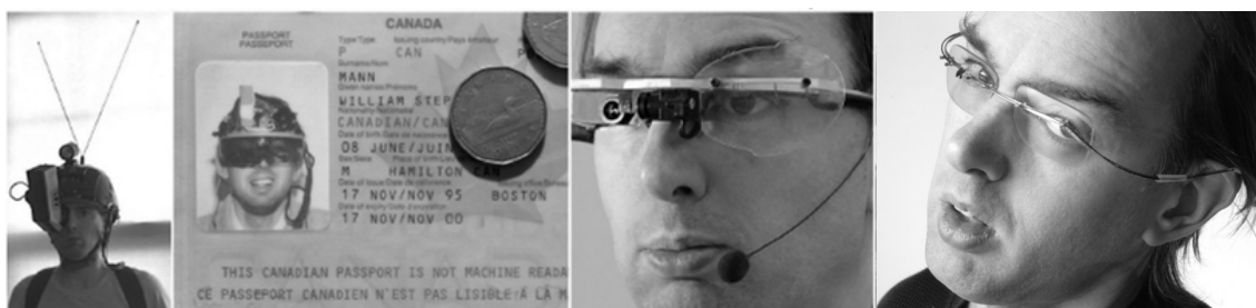
FIGURA 160 - Steve Mann, evolução da computação vestível: 1980, 1995, 1999 e, em 2004, com uma miniatura do dispositivo "Eye Tap" que usa fibra ótica para levar imagens aos olhos
