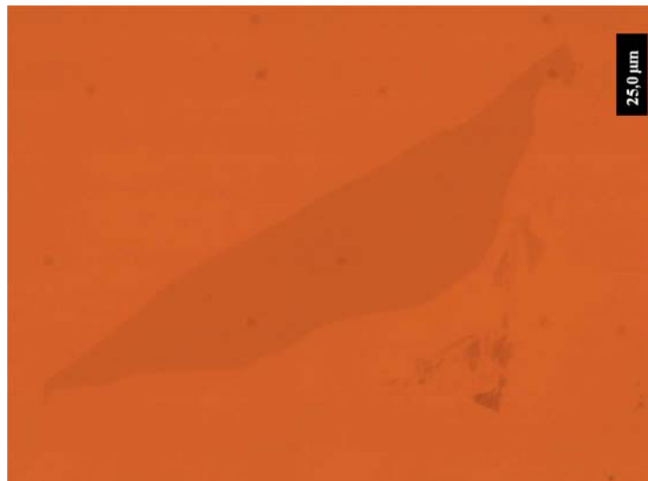
Figura 2.2: Imagem de microscopia óptica de uma amostra de uma camada única de grafeno, depositada sobre um substrato de Si/SiO 2 . Essa amostra foi obtida pelo processo de clivagem micromecânica, no Departamento de Física da UFMG.
