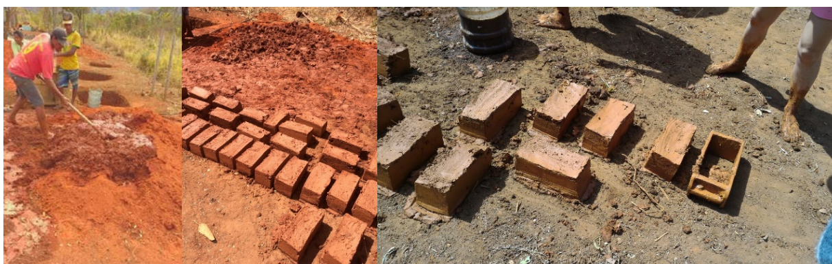
Figura 6 - Demonstração do processo de produção do adobe por adobeiro local da Lapinha da Serra, MG, em visita de estudos de 2017 Fonte: Acervo da autora
