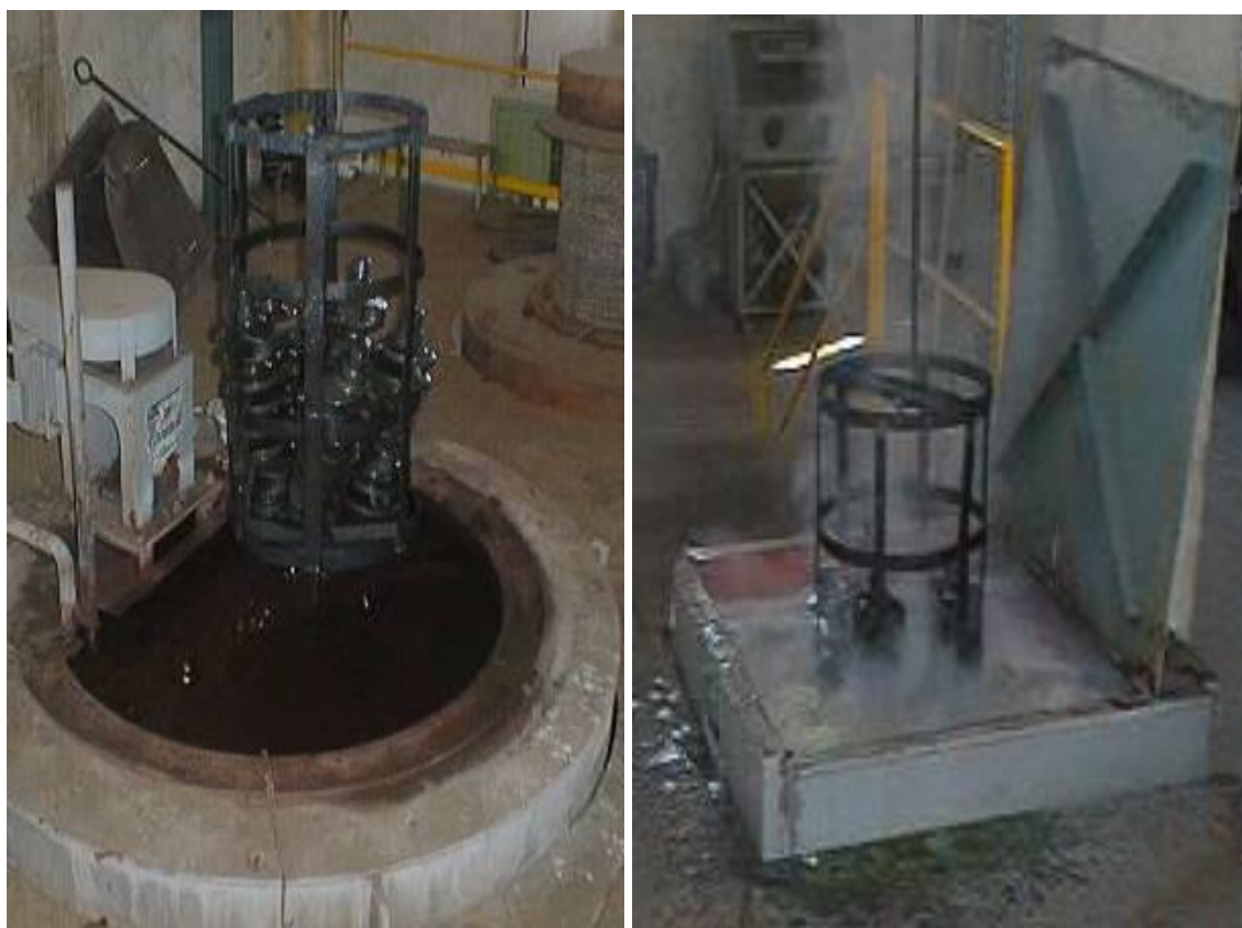
FIGURA 4.4 A) Retirada do cesto do banho de sais, B) Mergulho do cesto no tanque de lavagem.
