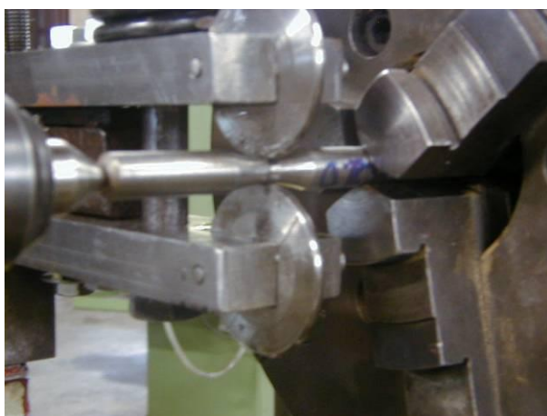
FIGURA 4.11 - Rolagem de corpos de prova no torno mecânico.
