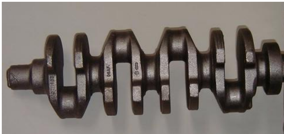
FIGURA 4.1 - Virabrequim modelo TF 8193.1. Massa bruta de fundição de 22 kg.
