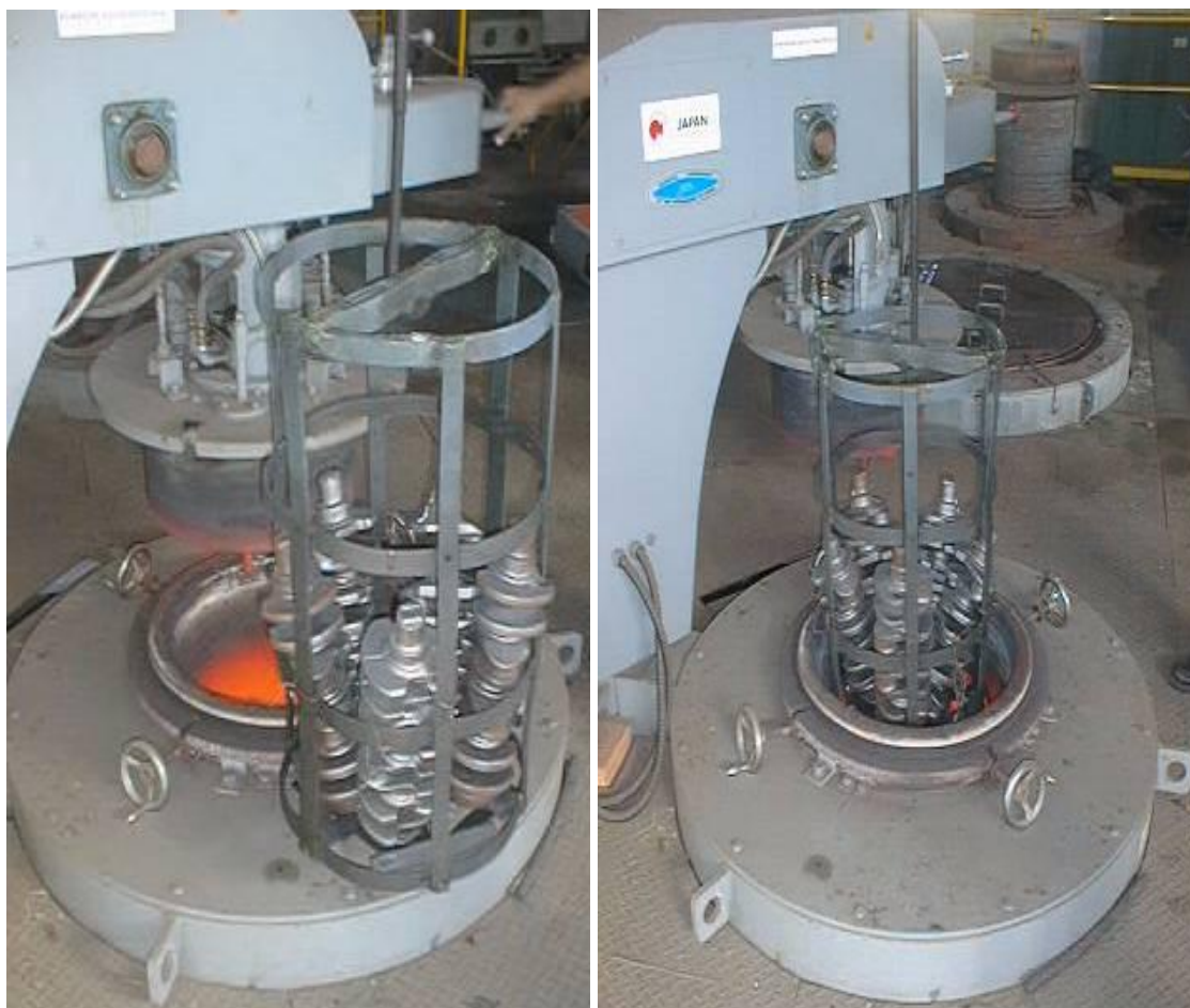
FIGURA 4.2 - Carregamento do cesto com cinco peças dentro do forno.
