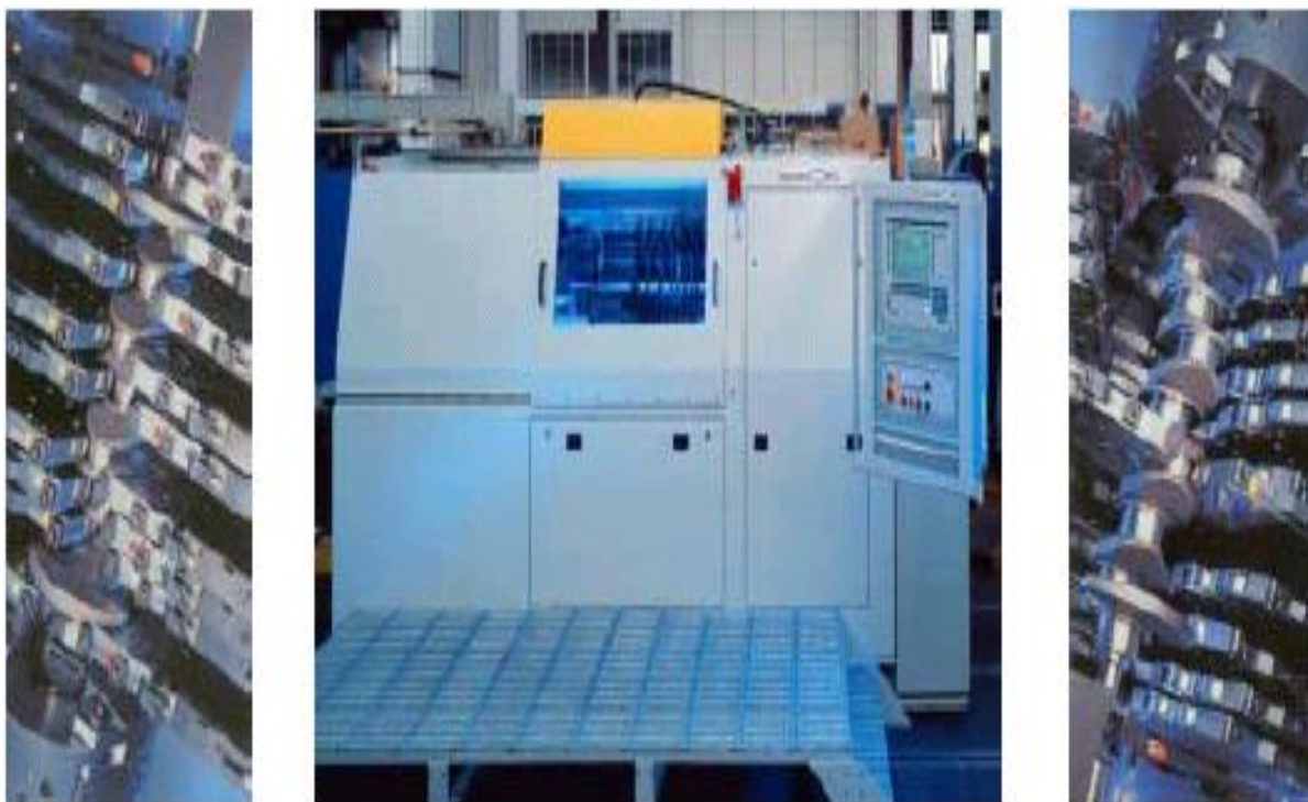
FIGURA 3.13 - Máquina comercial para rolagem de virabrequins. FONTE: VACCARI (1990)
