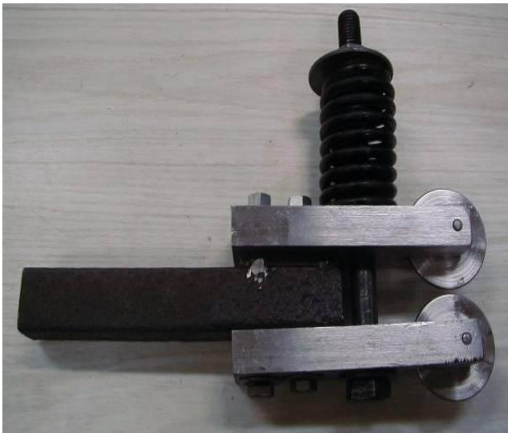
FIGURA 4.10 - Dispositivo para rolagem de corpos de prova.
