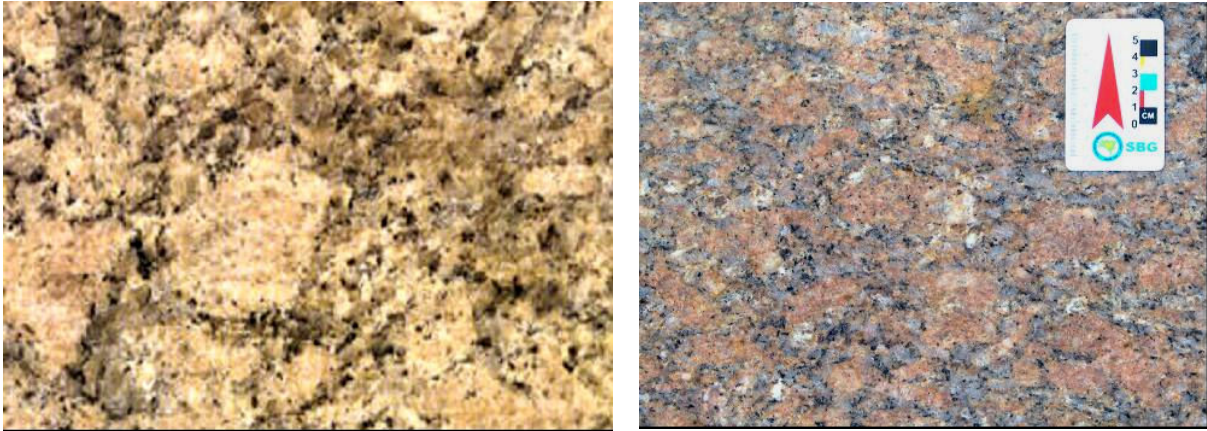
Figura 95. Leucogranito Carlos Chagas indeformado (MP21; 340892 / 7931068), com textura ígnea preservada, na variedade comercial Giallo Veneziano (GRANASA). A cor amarela se deve ao intemperismo muito incipiente (o fenocristal de feldspato potássico do centro da foto da esquerda tem 7 cm na maior dimensão). Os zircões datados foram retirados de amostra da rocha completamente fresca, rosada (na foto com escala).
