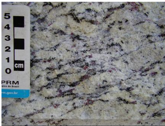
Figura 42. Leucogranito Carlos Chagas foliado. A foliação regional é destacada pelo estirramento dos porfiroclastos oclares de feldspato potássico (NV51; 343674/ 7951453).
