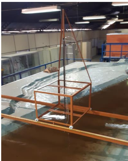
Figura 5-4: Suporte sobre trilhos para fixação do velocímetro ADV
