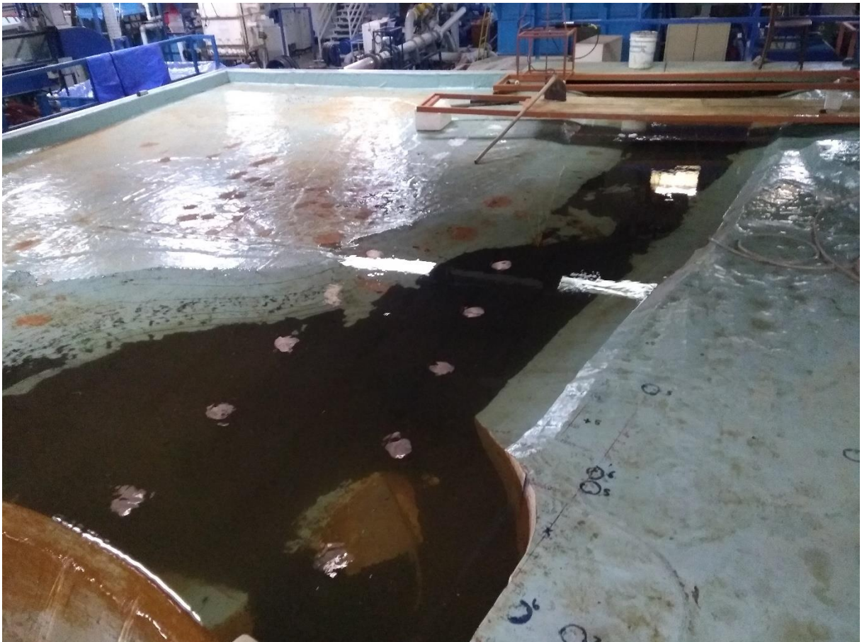
Figura 6-8: Geometria de praia obtida ao final da simulação
