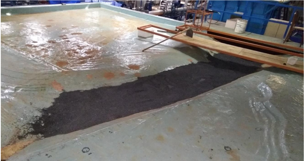
Figura 6-7: Disposição dos sedimentos previamente à conformação da praia pelo escoamento
