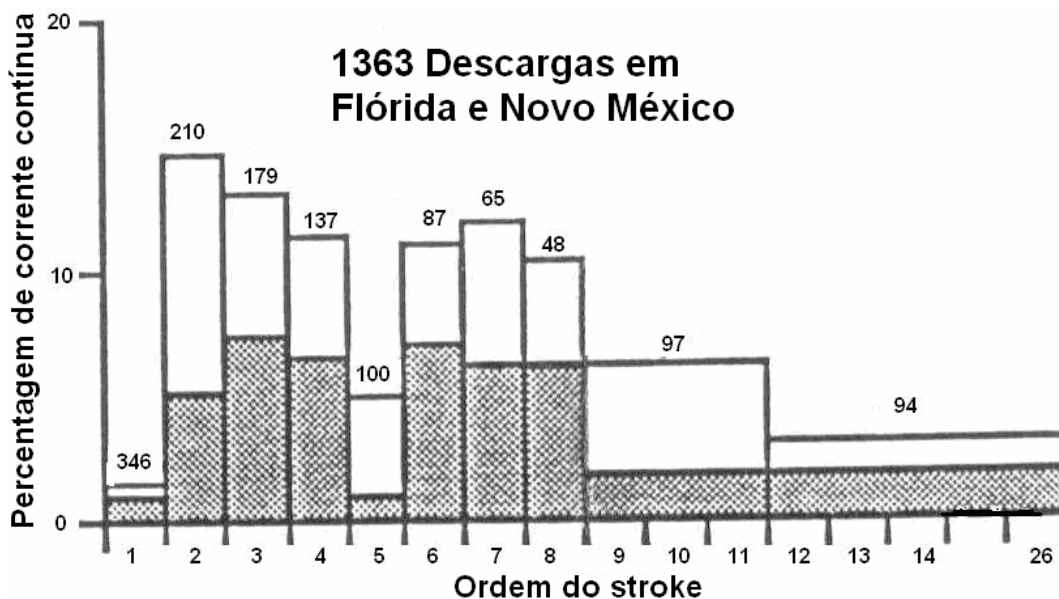
Figura 2.14 - Relação entre a CCLD e a ordem de corrente de retorno [Rakov e Uman,1990].
