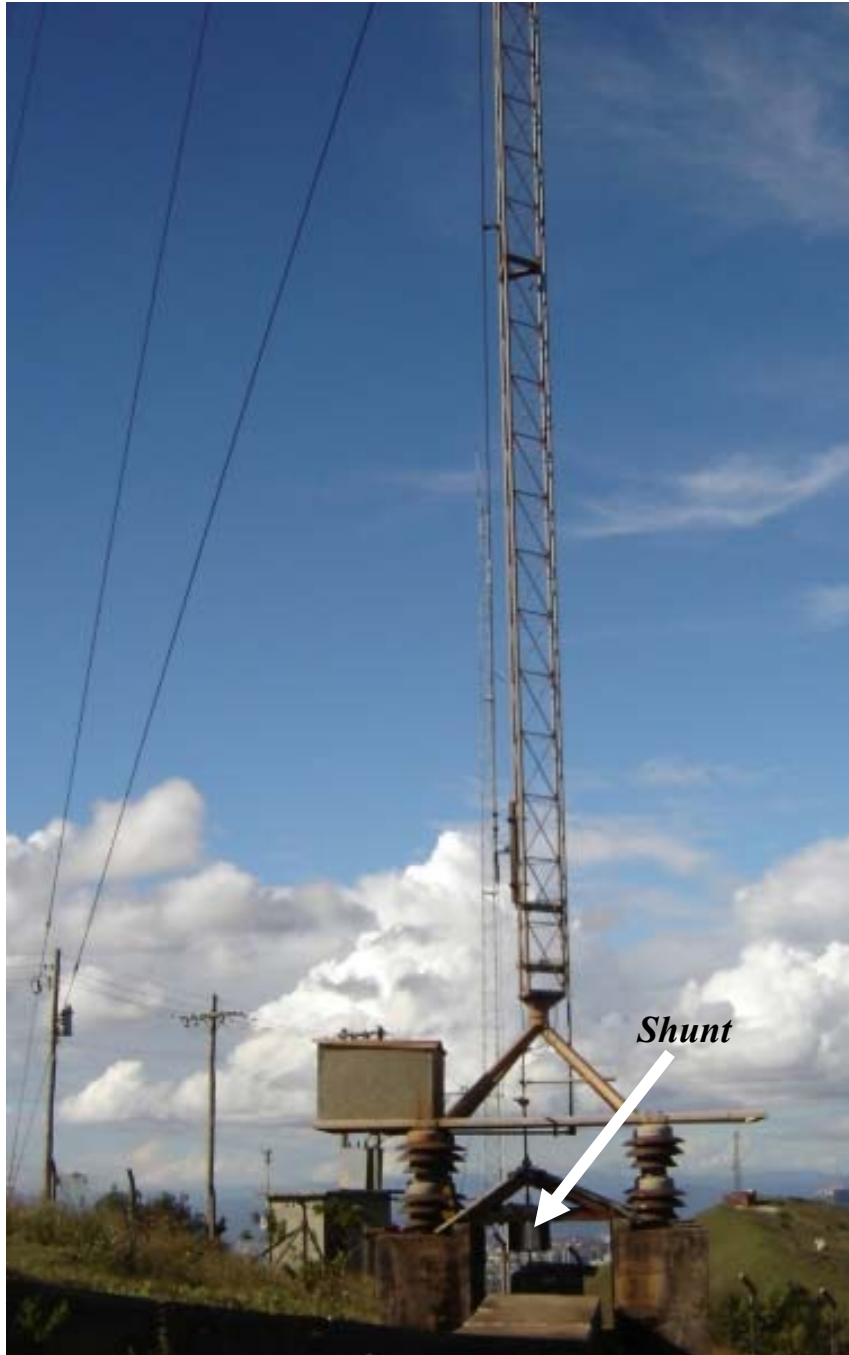
Figura 3.8 – O transdutor resistivo instalado na base da torre para medição de corrente de descarga.
