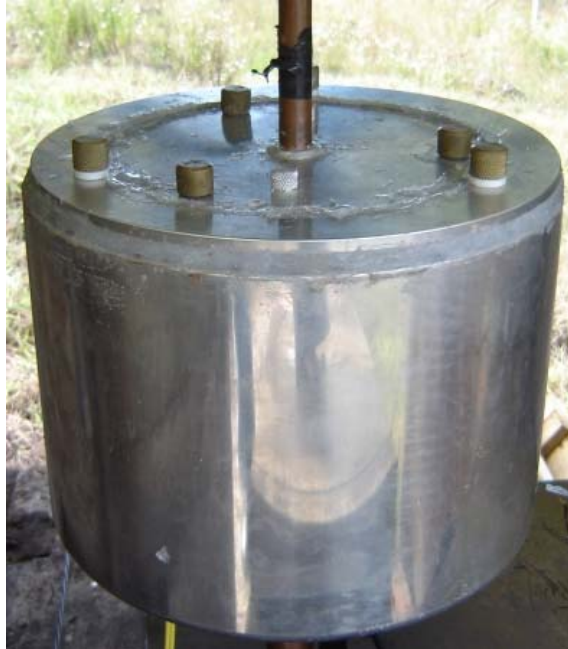
Figura 6.2 – Transdutor resistivo coaxial na base da torre.
