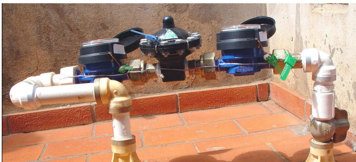
Figura 3.13- Cavalete especial montado para verificação da influência do eliminador de ar na medição do consumo de água na rede de distribuição (Souza et al , 2006).
