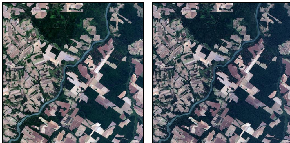
FIGURA 21 - Comparação entre duas imagens em mesma composição de bandas (RGB432 - cor natural), em um mesmo trecho da área de estudo, em que é possível se observarem quão semelhantes são as cores da imagem fusionada com o método Brovey (direita) em relação à imagem original (esquerda)
