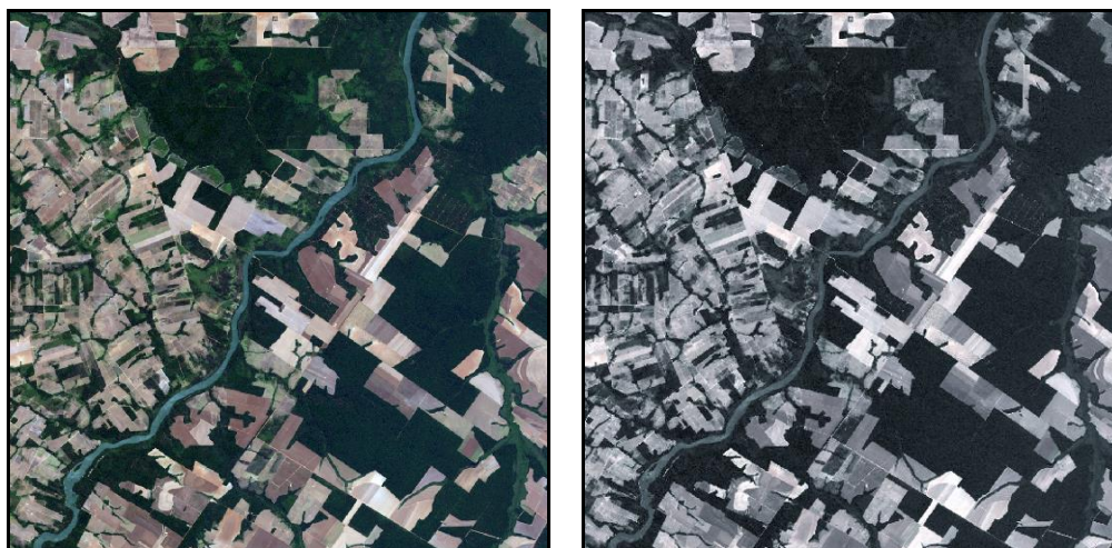
FIGURA 18 - Comparação entre duas imagens na composição colorida RGB432 (cor natural), de um mesmo trecho da área de estudo. A imagem da esquerda corresponde à imagem de 30 metros, não fusionada, e a da direita, à imagem fusionada pelo método IHS. Conforme pode ser observado, embora ambas as imagens apresentem a mesma composição de bandas, a imagem da direita apresentou aspecto visual bem destoante da imagem da esquerda, aparentando estar em tons de preto e branco
