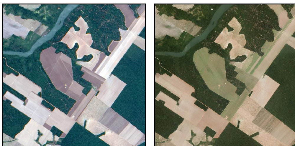
FIGURA 22 - Comparação entre um trecho da área de estudo visto na imagem de satélite (esquerda) e na ortofoto (direita), ambas em composição colorida RGB432 (cor natural), evidenciando diferenças na cobertura do solo, devido ao imageamento ter sido realizado em períodos diferentes
