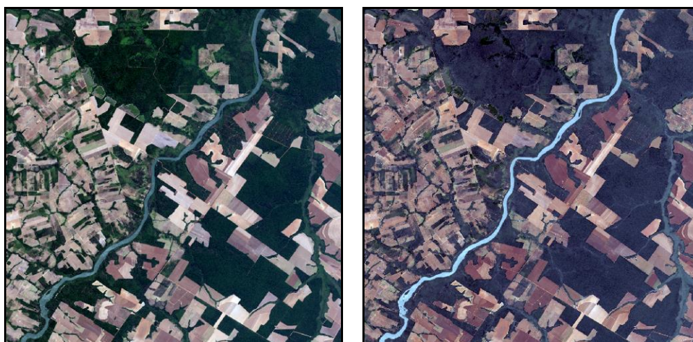
FIGURA 20 - Comparação entre duas imagens em mesma composição de bandas (RGB432 - cor natural), em um mesmo trecho da área de estudo, onde é possível se observarem ainda variações na tonalidade das cores entre a imagem fusionada pelo método Gram-Schmidt (direita) e a imagem original (esquerda). Essas diferenças são notadas, principalmente, quando se observam a vegetação e os corpos hídricos
