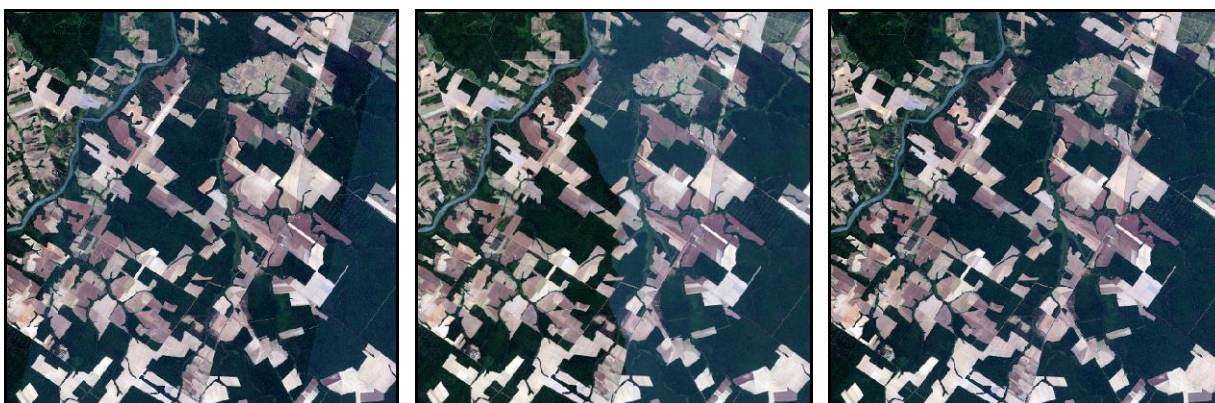
FIGURA 17 - Comparação entre os métodos de mosaicagem Mean (esquerda), Seamline (centro) e Feathering (direita). Reparar as cicatrizes paralelas e oblíquas na imagem da esquerda, e a linha de corte irregular na imagem central. Não se pode perceber na imagem da direita a ocorrência de cicatrizes de mosaicagem
