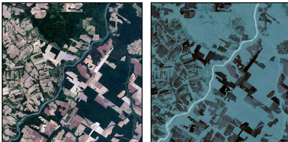
FIGURA 19 - Comparação entre duas imagens em mesma composição de bandas (RGB432 - cor natural), em um mesmo trecho da área de estudo, em que é possível observar o quão destoante ficou o aspecto visual da imagem fusionada pelo método Principal Components (direita), em relação à imagem original não fusionada (esquerda)
