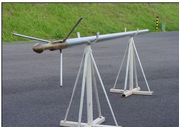
Figura 4.5: Sonda 3ACS – 3 Arm Caliper Sonde, com as hastes (braços) abertas.
