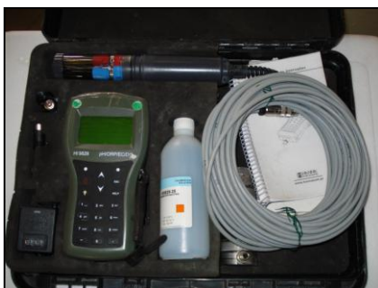
Figura 4.15: Sonda Multi parâmetros Hanna modelo HI 9828.
