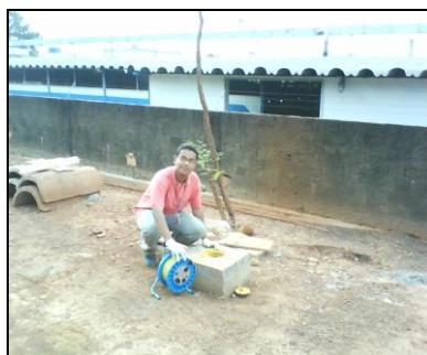
Figura 4.14: Leitura de recuperação com medidor de N.A. no PM 02.
