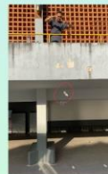
Figura 3: Experimento de queda das caixas de fósforo comprovando que a aceleração da gravidade atua da mesma forma em corpos de massas diferentes.
