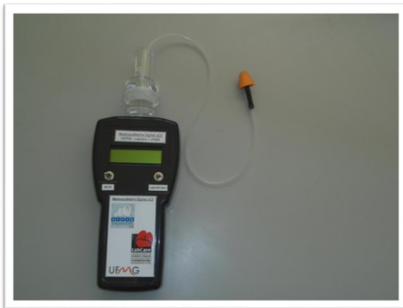
FIGURA 3: Manovacuômetro digital (NEPEB-LabCare/UFMG, Belo Horizonte-MG, Brasil) com o prolongamento de silicone e plugue nasal.
