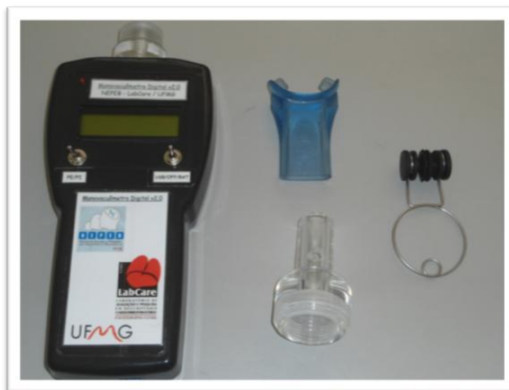
FIGURA 2: Manovacuômetro digital (NEPEB-LabCare/UFMG, Belo Horizonte-MG, Brasil) com peça acrílica, bocal do tipo mergulhador e clipe nasal.
