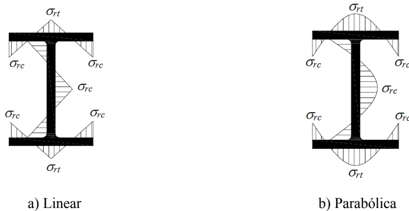
Figura 3.52 – Distribuição simplificada das tensões residuais estudada por Almeida (2006)
