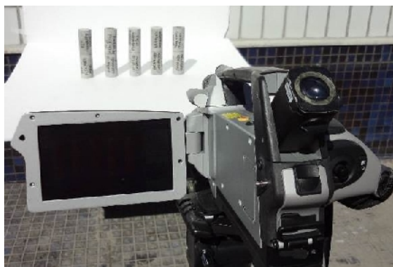
Figura 25 - Equipamento de termografia: câmera termográfica.
