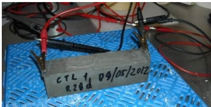
Figura 20 - Equipamento de resistividade elétrica – Portugal.
