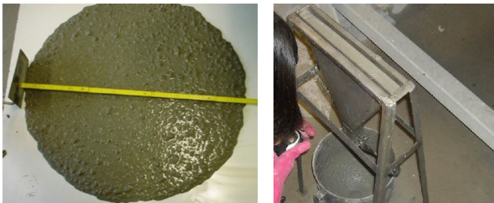
Figura 16 - Medição da trabalhabilidade por tronco de cone e funil.
