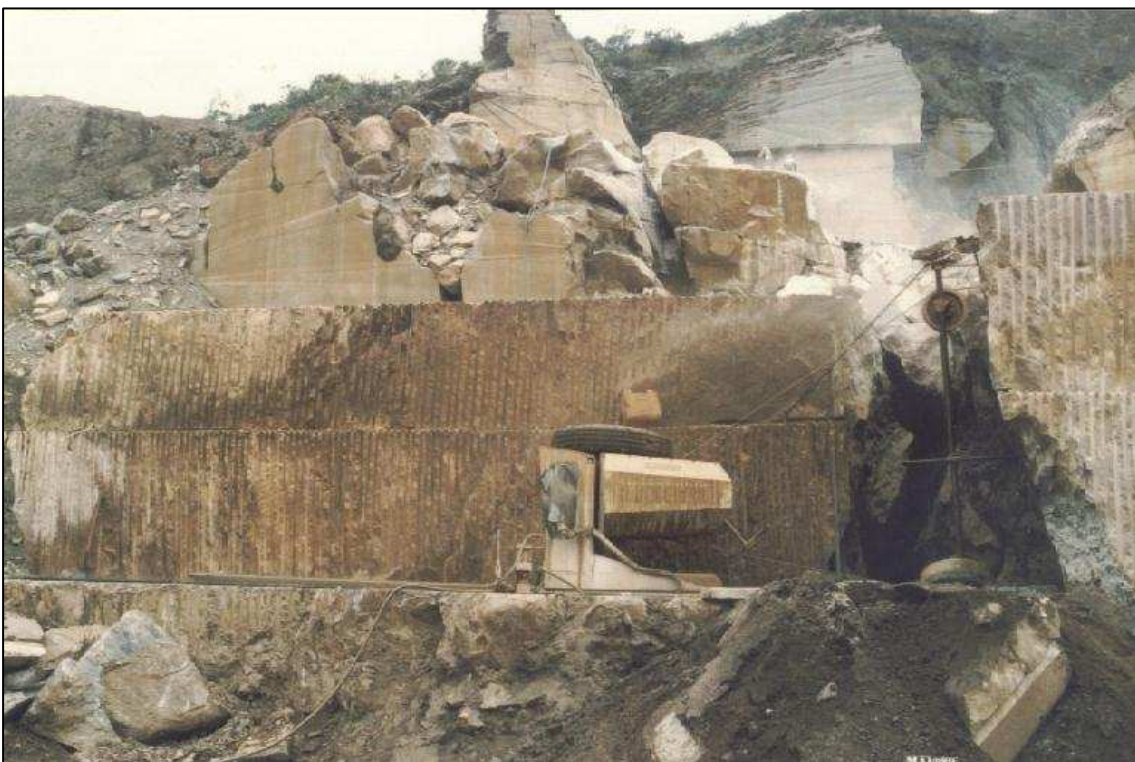
Foto 5.4: Corte com fio diamantado em plano vertical.
