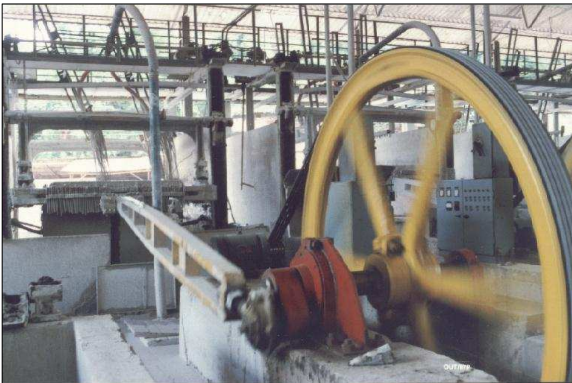
Fotos 3.5 a,b: Processo de serragem em um tear, usando uma mistura de granalha, cal hidratada e água feita com circulação em sistema fechado; vistas frontal e posterior (pedreira do Cumbi).
