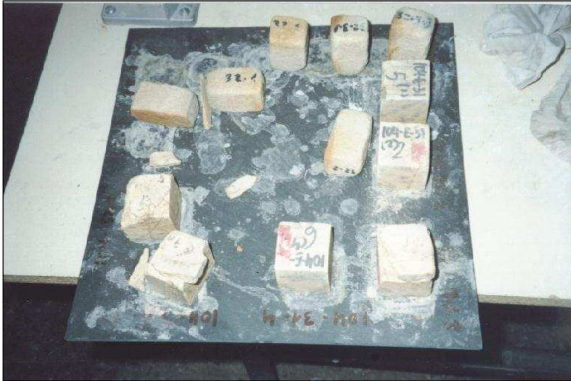
Foto 3.6: Travertino submetido à tensões internas devido a cristalização de sais em sua matriz (LOEMCO-Espanha)
