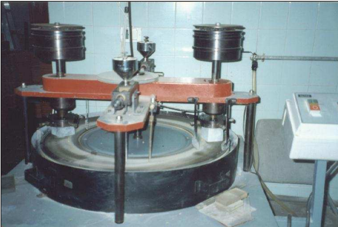
Foto 3.8: Através de pesos e abrasivos, ocorre o desgaste dos CP, que é seguida medido e avaliado (LOEMCO).
