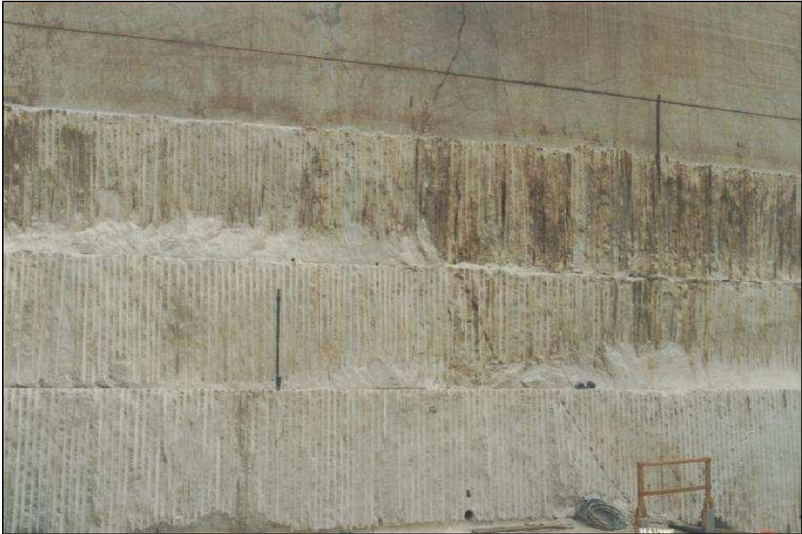
Foto 6.4: Lente de dolomito claro com fraturas persistentes, onde foi feito o perfil horizontal (9-2).
