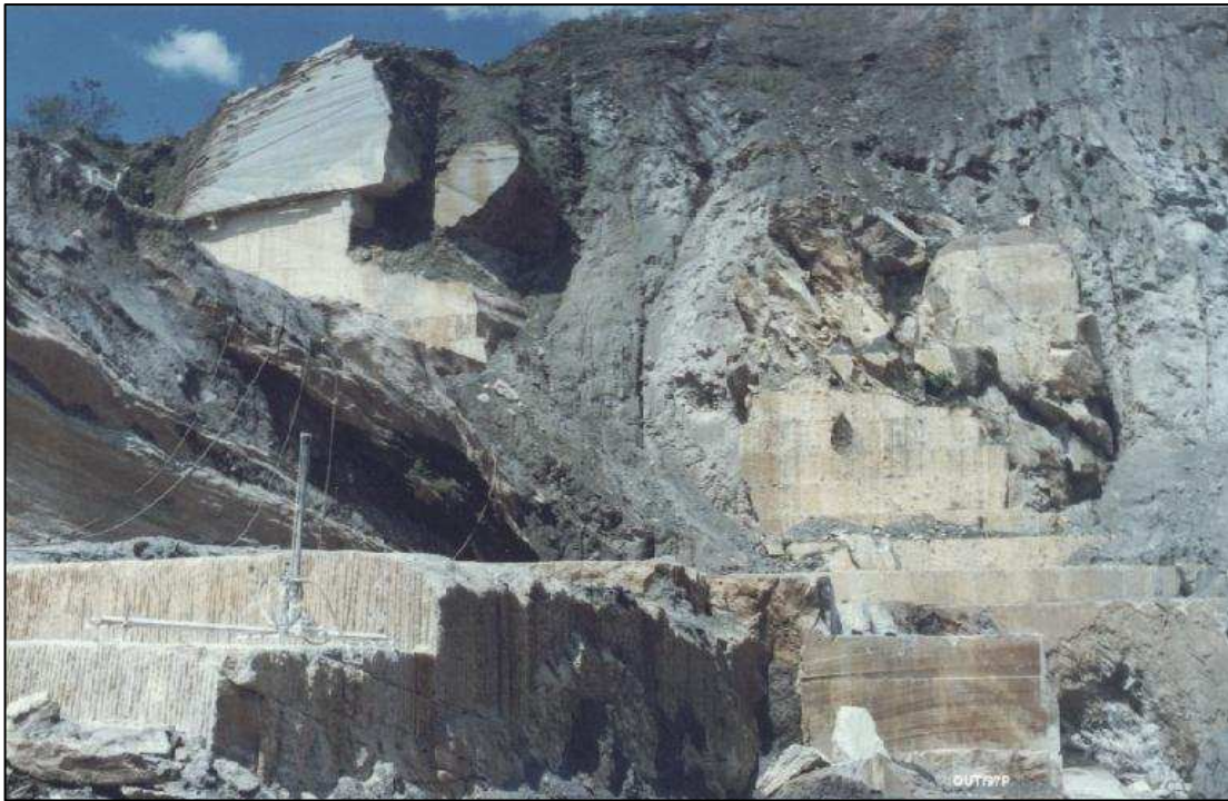
Foto 4.1: Lentes de dolomito na principal frente de lavra (Lapa). Na lente superior esquerda observa-se um contato difuso entre o filito cinza-azulado e a lente dolomítica.
