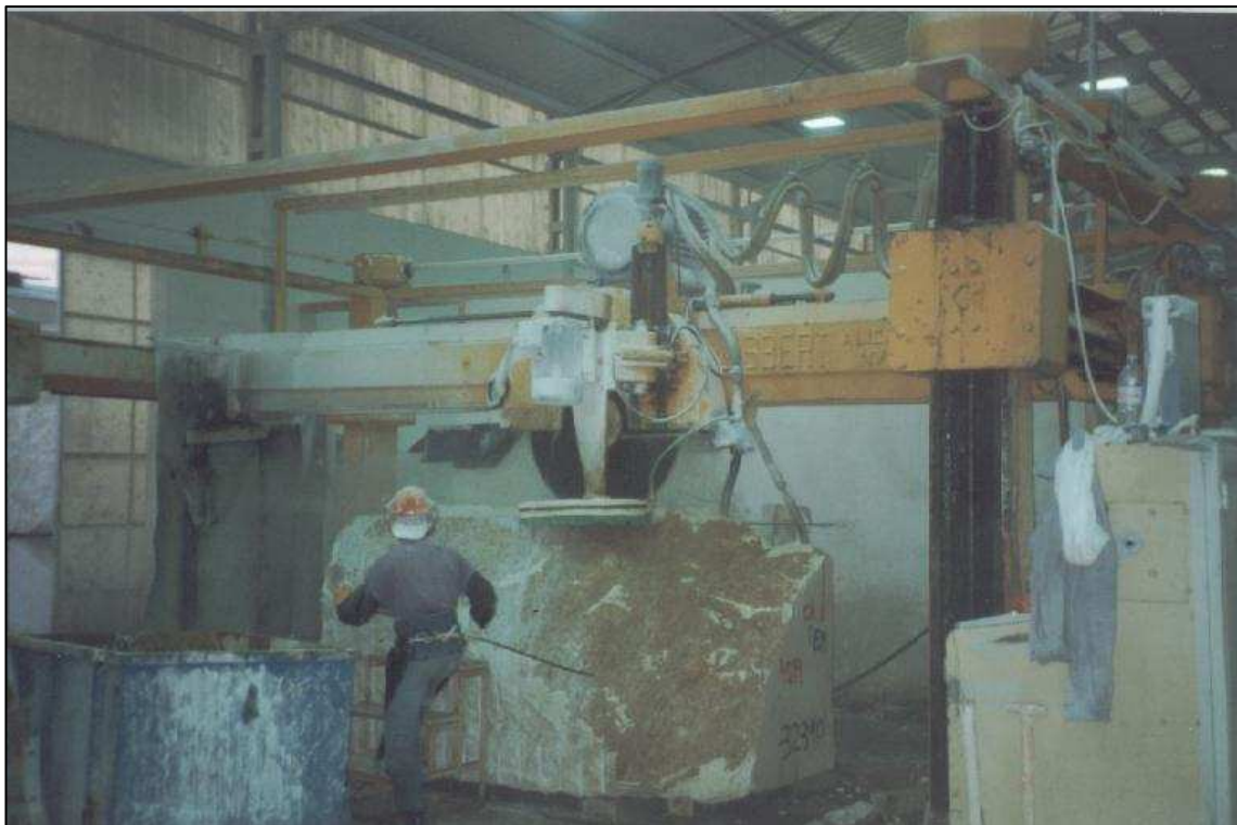
Foto 3.4: Talha-blocos, usado no aproveitamento de blocos menores e não uniformes (Esteve & Mañez, Alicante, Espanha).
