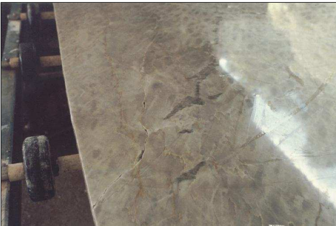
Foto 5.6: Trinca ao longo de fina camada de sericita, logo após o processo de polimento.
