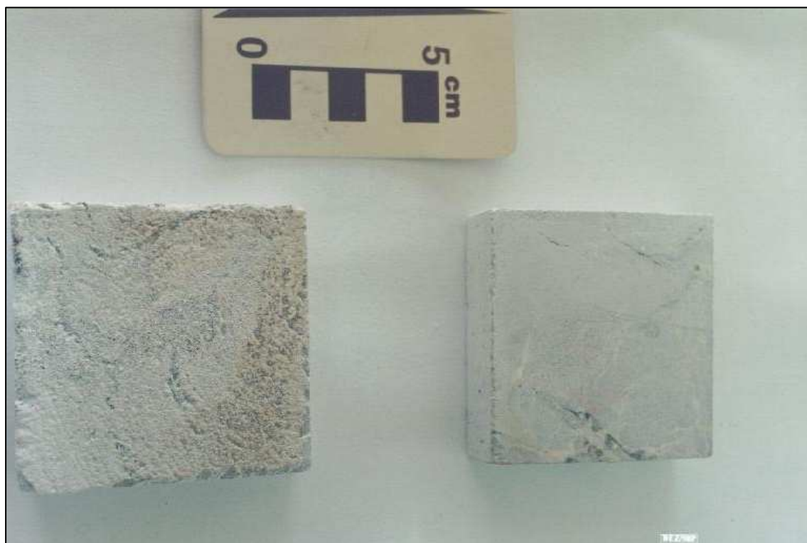
Foto 6.10: Comparação do desgaste com vapores de \text{SO}_2 da face não polida e polida do dolomito Jacarandá.
