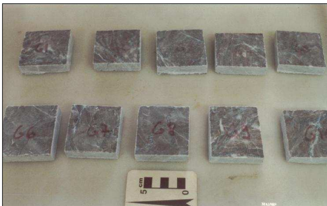
Foto 6.7: Corpos de prova do dolomito Jacarandá (dimensões 7x7x2cm).
