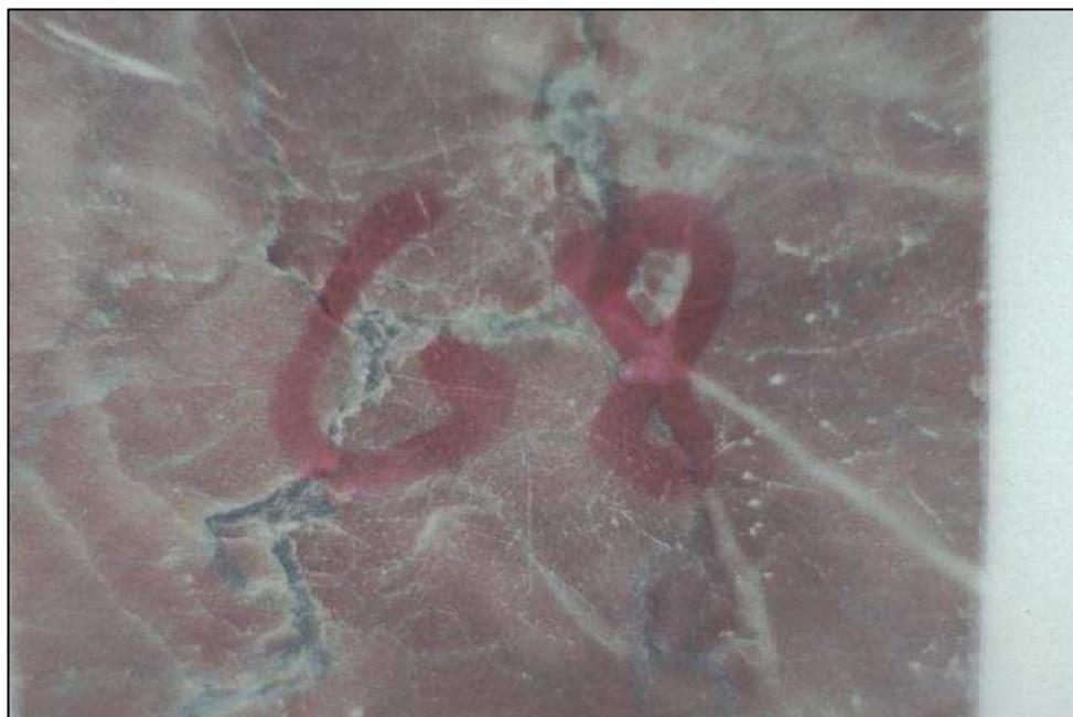
Foto 6.9: Detalhe do dolomito Jacarandá antes do teste com vapores de ácido.
