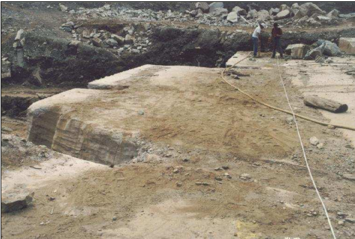
Foto 6.1: Bancada onde foram realizados os perfis 3 (N-S) e 6 (S-N). As fraturas abertas se prolongam em profundidade, gerando um padrão de reflexão hiperbólico.
