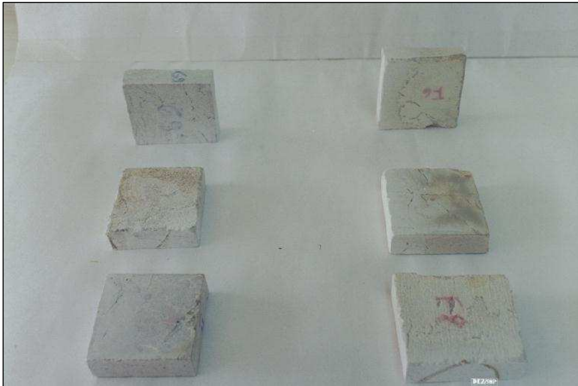
Foto 3.7: CP submetidos ao ataque ácido: aurora pérola (dir.) e jacarandá (esq.) – Lab. CPMTIC-IGC-UFG.
