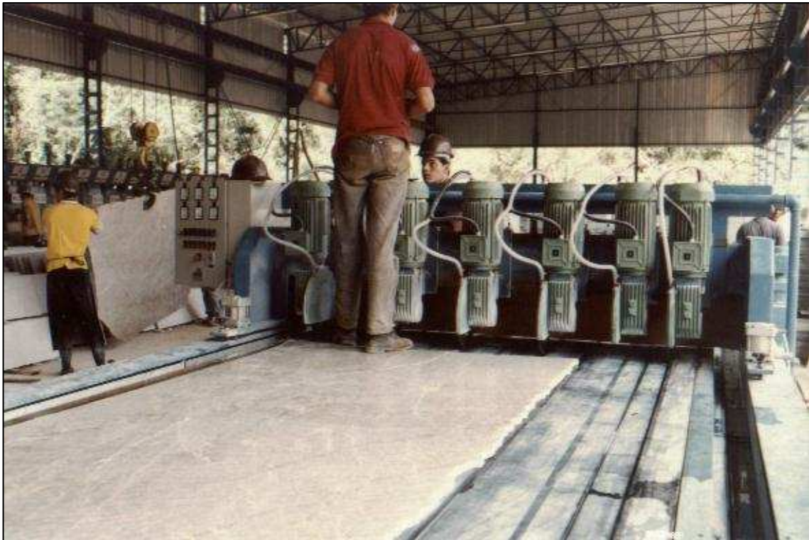
Foto 3.3: Multiserra na linha de ladrilhos padronizados (pedreira do Cumbi).
