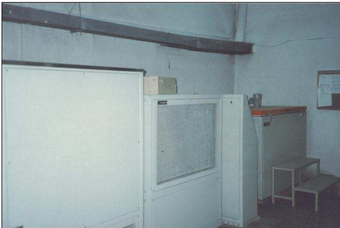
Foto 3.10: Câmara automática de congelamento e degelo (LOEMCO).
