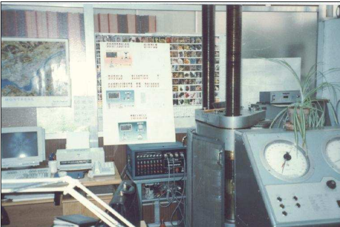
Foto 3.9: À direita vê-se a prensa (com tela de proteção) e à esquerda o sistema DATAC e computador com placa e programa de aquisição de dados (Lab. Mecânica Rocas –UPM).
