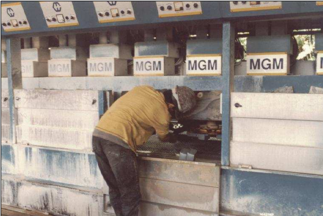
Foto 5.5: Troca de elemento abrasivo em poltriz automática.
