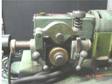
Figura 6.4 - Sistema de roletes responsável pelo arraste do arame (acionado).
