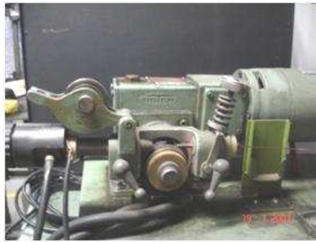
Figura 6.3 - Sistema de roletes responsável pelo arraste do arame (desacoplado).
