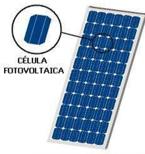
Figura 2: Módulo fotovoltaico evidenciando a célula fotovoltaica
