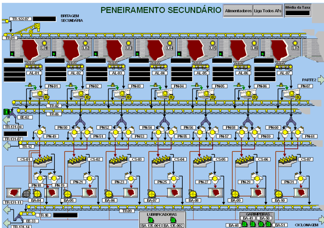
Figura 33 – Tela de operação do Peneiramento Secundário
