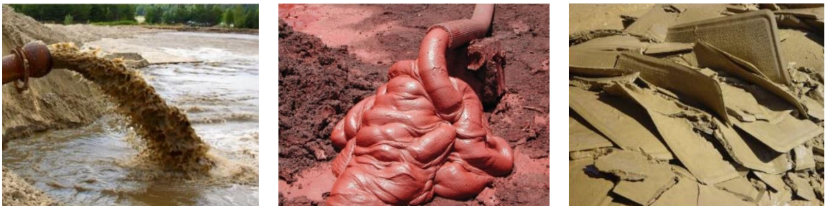
Figura 6 É Rejeito na forma de Polpa (a), Pasta (b) e Torta (c) (a) Polpa (b) Pasta (c) Torta
