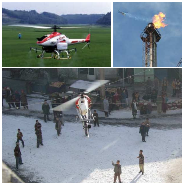
Figura 1.3: Uso de helicópteros não-tripulados em aplicações comerciais. À esquerda, no alto, pulverização de culturas no Japão [Sato, 2003]. No alto e à direita, modelo da empresa CopterFilms inspecionando uma chaminé em refinaria de petróleo na Argentina [CopterFilms, 2009]. Abaixo, filmagem de O caçador de pipas , pela empresa Flying-Cam [Flying-Cam, 2009].
