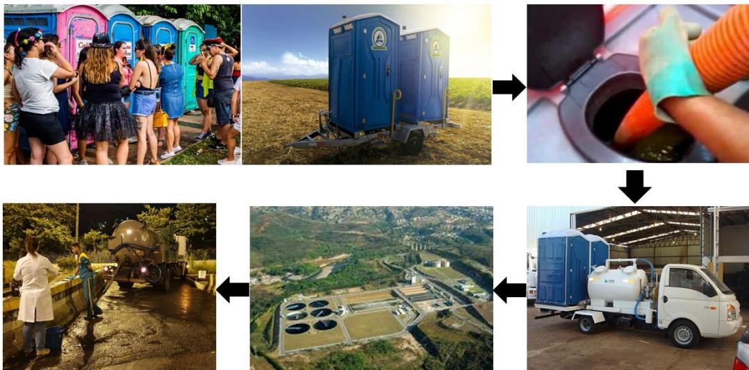
Figura 2 - Fluxograma prático da cadeia de uso, coleta, transporte e disposição final adequada de efluentes de banheiros químicos
