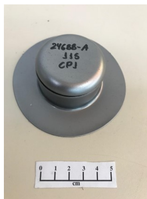
Figura 5.27 Exemplo de fratura em um dos corpos de prova no ensaio RLE.
