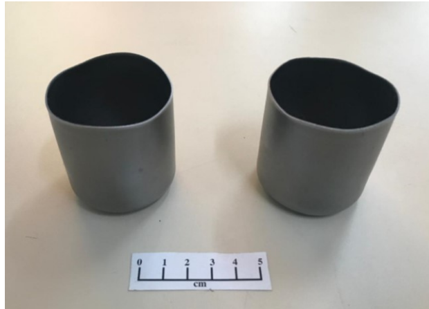
Figura 5.25 Copos formados no ensaio RLE. Esquerdo proveniente da bobina laminada a quente e direito da bobina laminada a morno.
