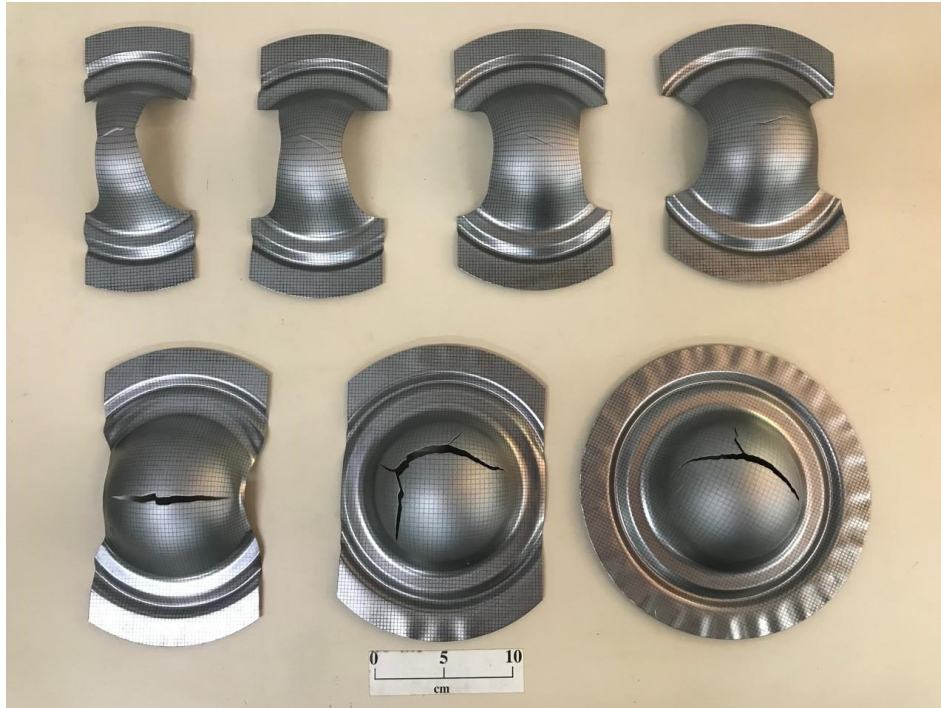
Figura 5.30 Exemplo dos corpos de prova após os ensaios de conformação para elaboração da CLC.
