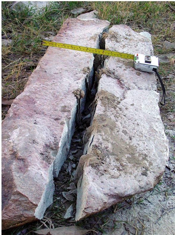
Figura 3 – Vista do bloco de quartzito após a evolução do plano de fratura: vinte horas
