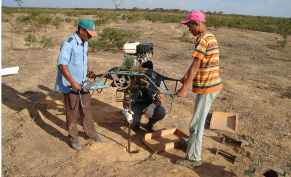
Figura 8: Coleta de solos com trado motorizado
