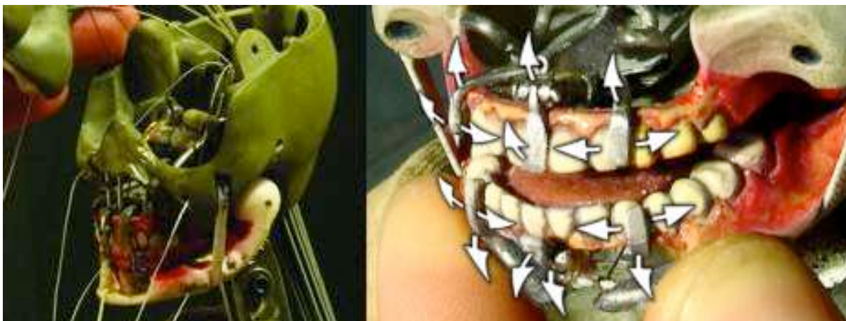
FIGURA 12. Aspecto dos cabos atravessando o crânio e as placas movimentadoras de lábios no design de Ron Cole. Fotos fornecidas pelo artista. Composição do autor.
