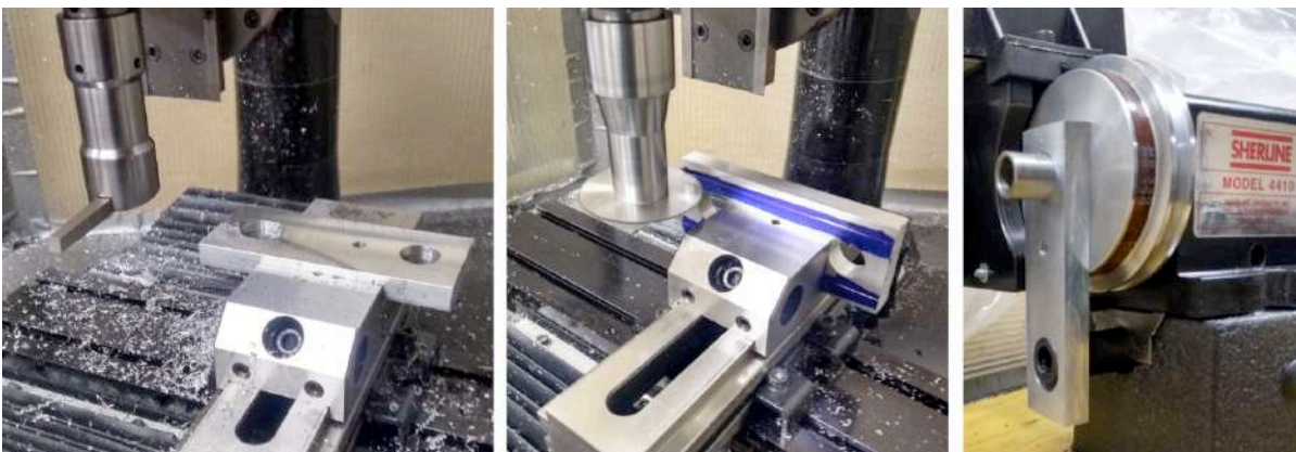
Figura 20. Plaina (à esquerda) e suporte de serras de 0.8mm (centro) fabricando o imobilizador de spindle do torno com a peça fixada na morsa retificada adquirida com a Taxa de Bancada. Fabricação e fotografias pelo autor.
