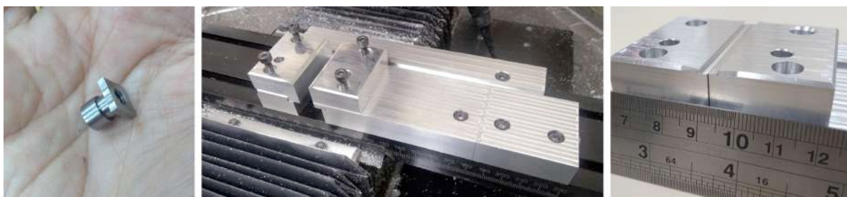
FIGURA 19. Porca T em aço 1045 para fixação à esquerda; vista geral da morsa baixa ao centro; detalhe dos mordentes reduzidos de 0.8 mm à direita. Fabricação e fotografia pelo autor.
