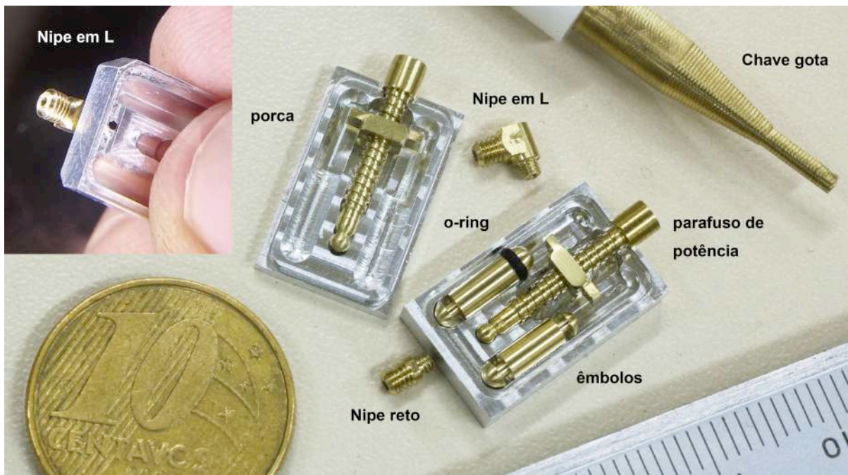
Figura 24. Componentes desmontados da caixa de controle de atuação primária hidropneumática. Vista giratória por macrofotografia em intervalômetro disponível em: https://youtu.be/HkkuwRMu-p0 Uma compilação de registros em vídeo dos diversos processos de usinagem para a ferramentaria e a fabricação desses componentes encontra-se em: https://www.youtube.com/playlist?list=PLQBdqk2O32BWvNgfysWZnZVtYo-9OMDQ Acesso permanente mantido pelo autor. Ferramentaria, usinagem, programação CNC, vídeos, fotografias, edição e composição realizados pelo autor.
