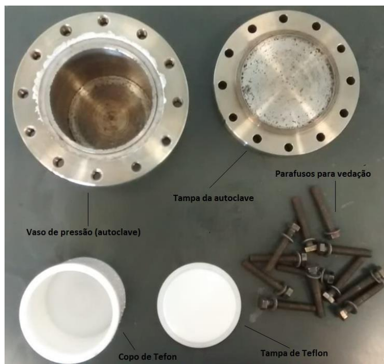
Figura 3.7: Vaso de pressão (autoclave) utilizado nesse estudo.
