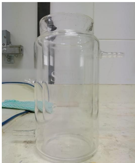
Figura 4.5: Fotoreator utilizado nos ensaios fotocatalíticos.
