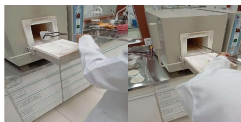
Figura 1 – Caracterização das cinzas e matéria orgânica do bagaço de malte
