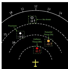
Figura 2. Visualização de aeronave pelo TCAS .
