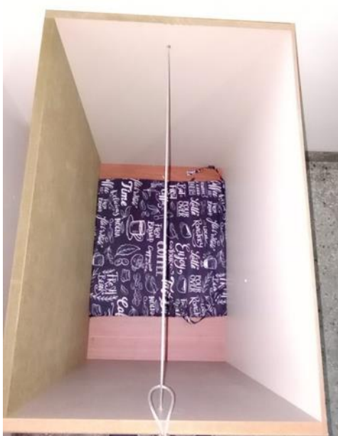
Figura 5. Teste de Suspensão - Caixa de suspensão.
