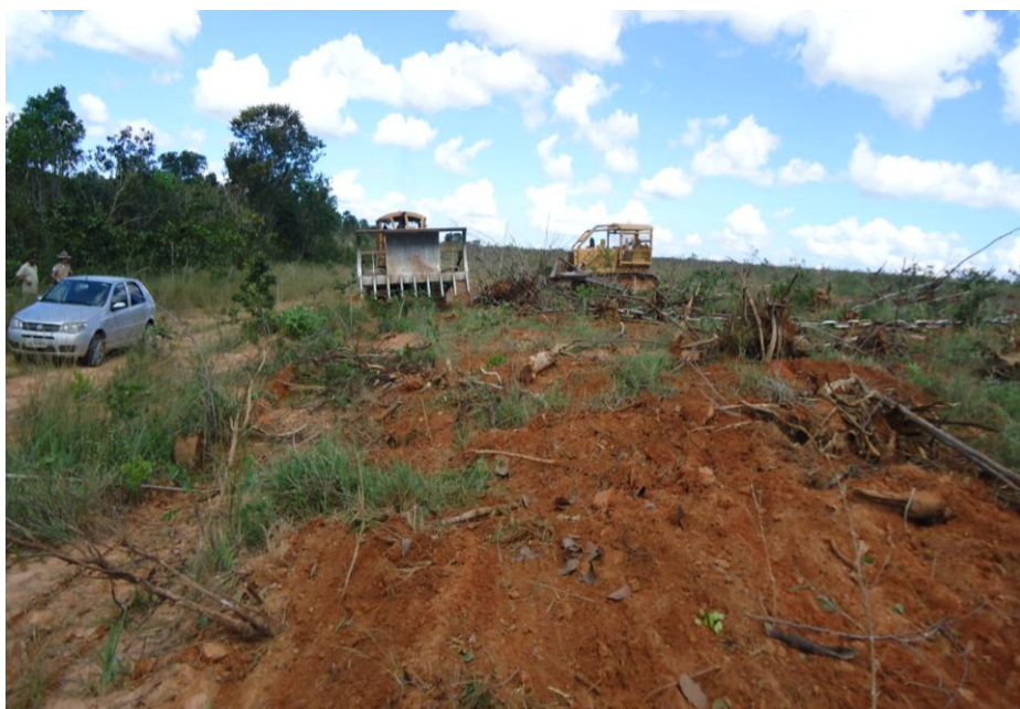
FIGURA 1- Tratores de esteira, com correntes, sendo usados para o preparo do solo (destoca), próximo a vereda em estudo. Fonte: Arquivo pessoal do autor
