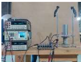
Figura 4.9- Sistema utilizado para o ensaio de resistividade elétrica.
