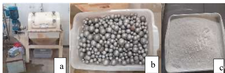
Figura 4.4 - a) Moinho de bolas horizontal; d) Carga utilizada no processo de moagem; c) Material obtido do processo de moagem.
