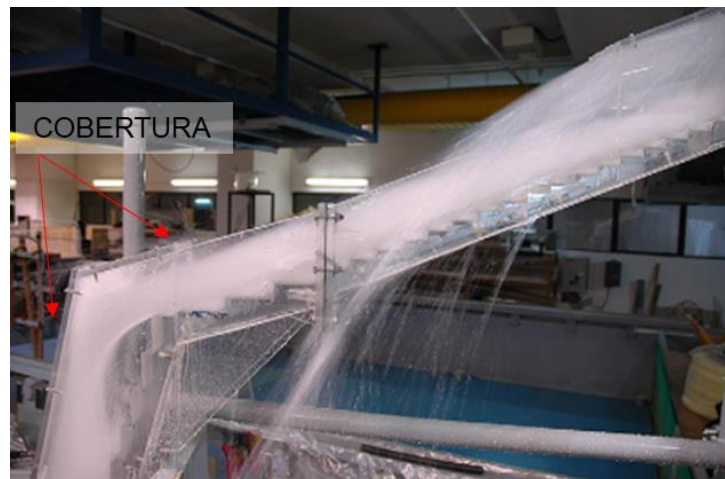
Figura 33 – Detalhe da operação da mudança de direção na estrutura.
