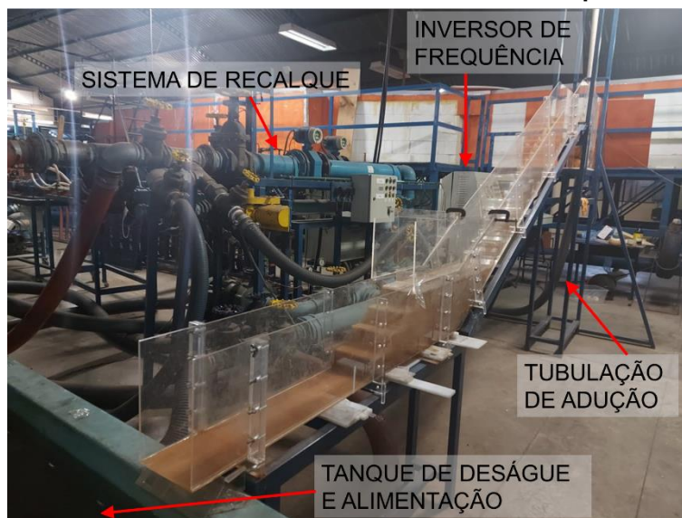
Figura 82 – Elementos externos da estrutura em estudo no aparato experimental
