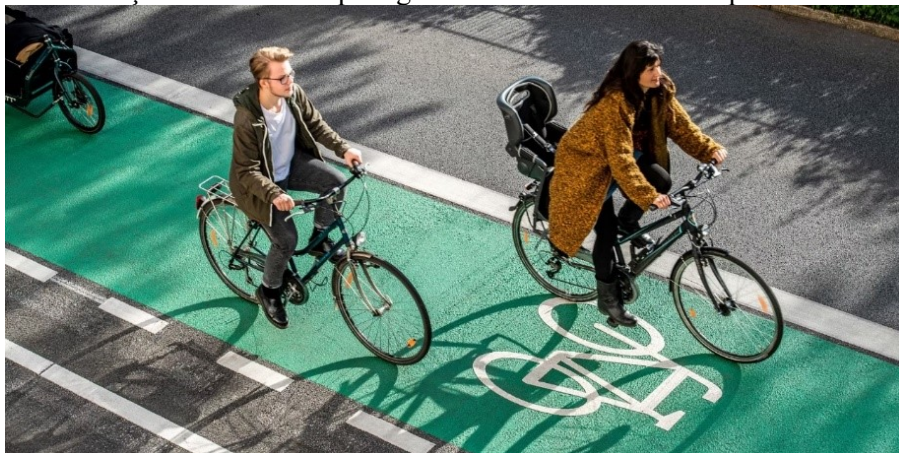
Figura 3.14: Pavimentação colorida com pictogramas brancos de bicicleta para demarcar a via ciclável
