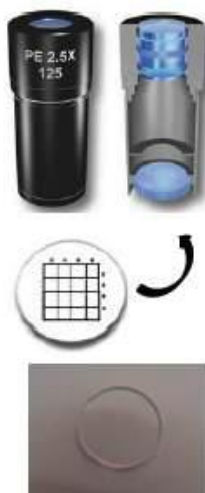
Figura 8. Retículo utilizado para análises morfométricas. O retículo apresenta uma área de 100 \mu\text{m}^2 e é acoplado à ocular do microscópio.
