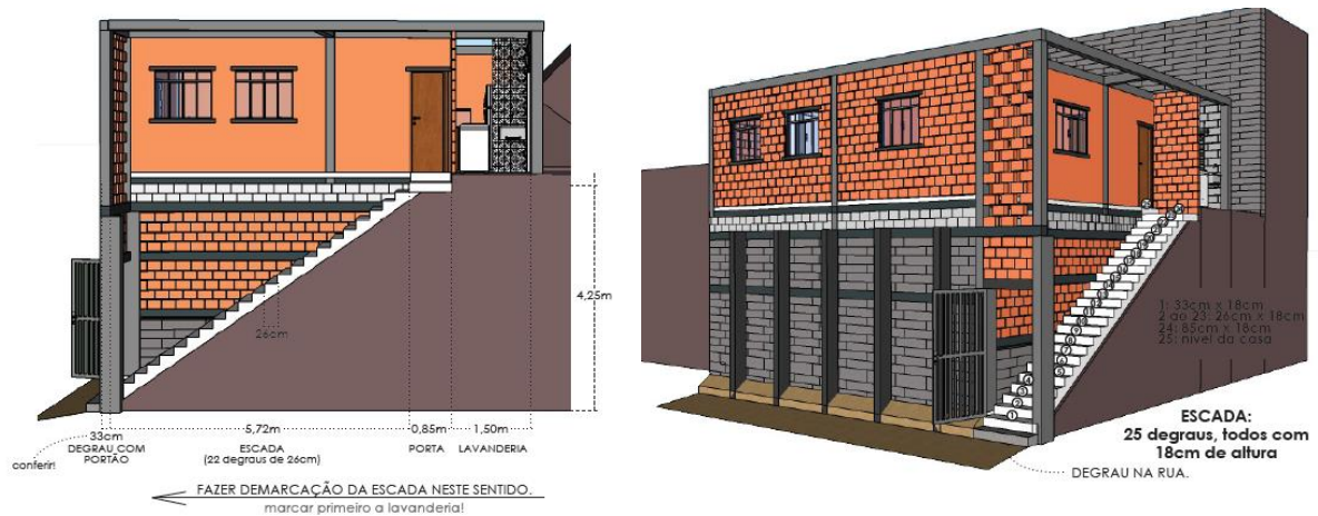
Figura 49 – Escada projetada especificamente para a casa da Beatriz – entregue à moradora também com o memorial dos cálculos para que pudessem sofrer adaptações.
