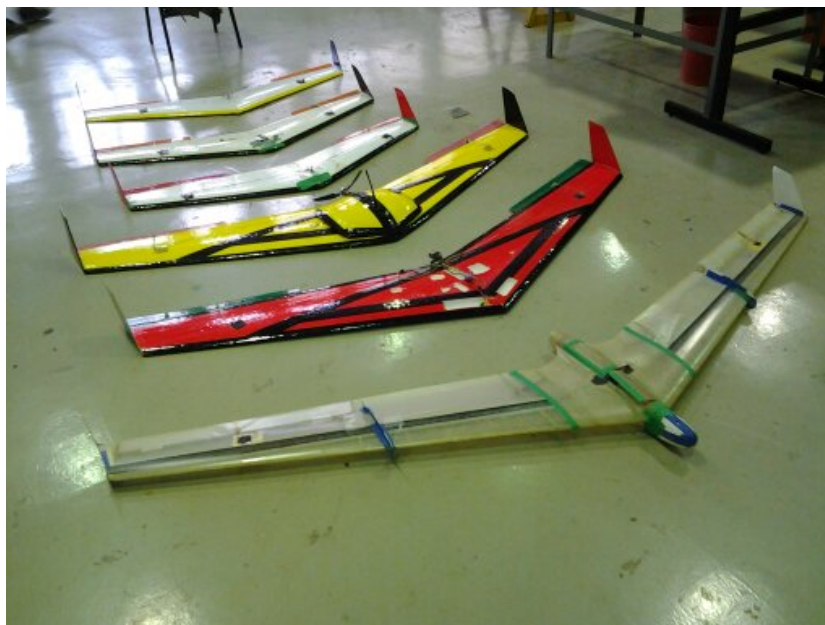
Figura A.2: Evolução da fuselagem dos VANTs desenvolvidos para suporte desse projeto. Ao fundo estão três modelos da Zagi original, em seguida há dois modelos de envergadura aumentada e enflechamento alterado, e por fim o modelo final da fuselagem, em fibra de vidro.
