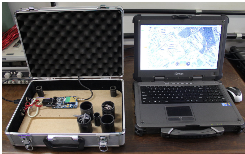
Figura A.4: Estação de Controle no Solo, composta por computador, modem sem fio e controle remoto.
