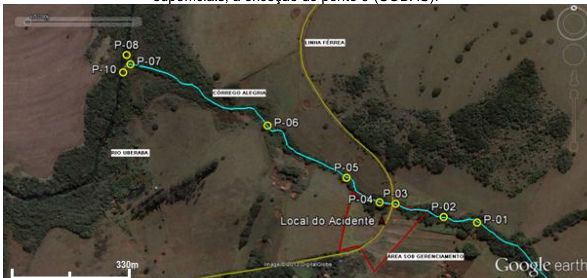
Figura 5.4 - Imagem aérea contemplando posicionamento dos pontos de coleta de águas superficiais, à exceção do ponto 9 (CODAU).
