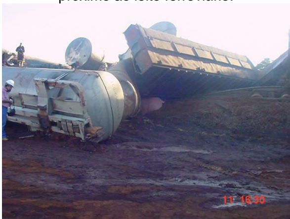
Figura 1.4 - Vazamento de alcoóis proveniente de vagão-tanque tombado próximo ao leito ferroviário.
