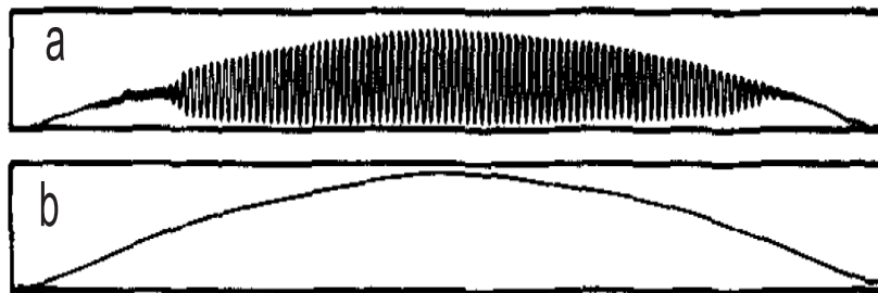
Fig. 7.1: Auto-oscilações observadas experimentalmente por McCall, reportadas no artigo da referência [56]. A figura (b) representa a intensidade de bombeio da cavidade e (a) representa a intensidade emitida pela microcavidade.
