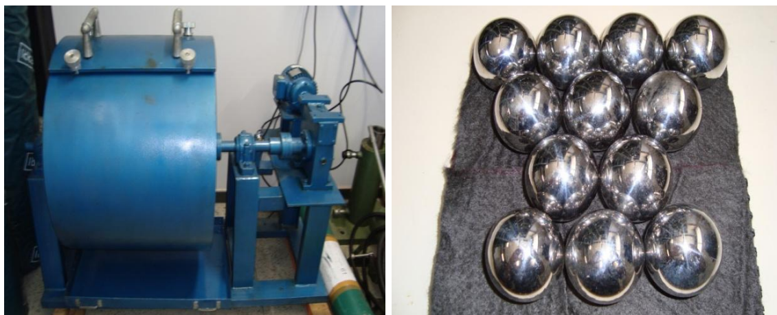
Figura 3.5 - Máquina Los Angeles e as cargas abrasivas
