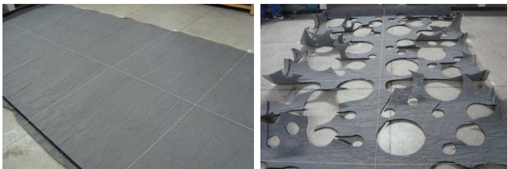
Figura 3.3 - Amostragem aleatória estratificada do geossintético para obtenção das amostras
