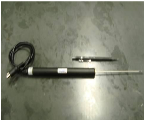
Figura 3.18 - Termopar tipo espeto utilizado nos ensaios
