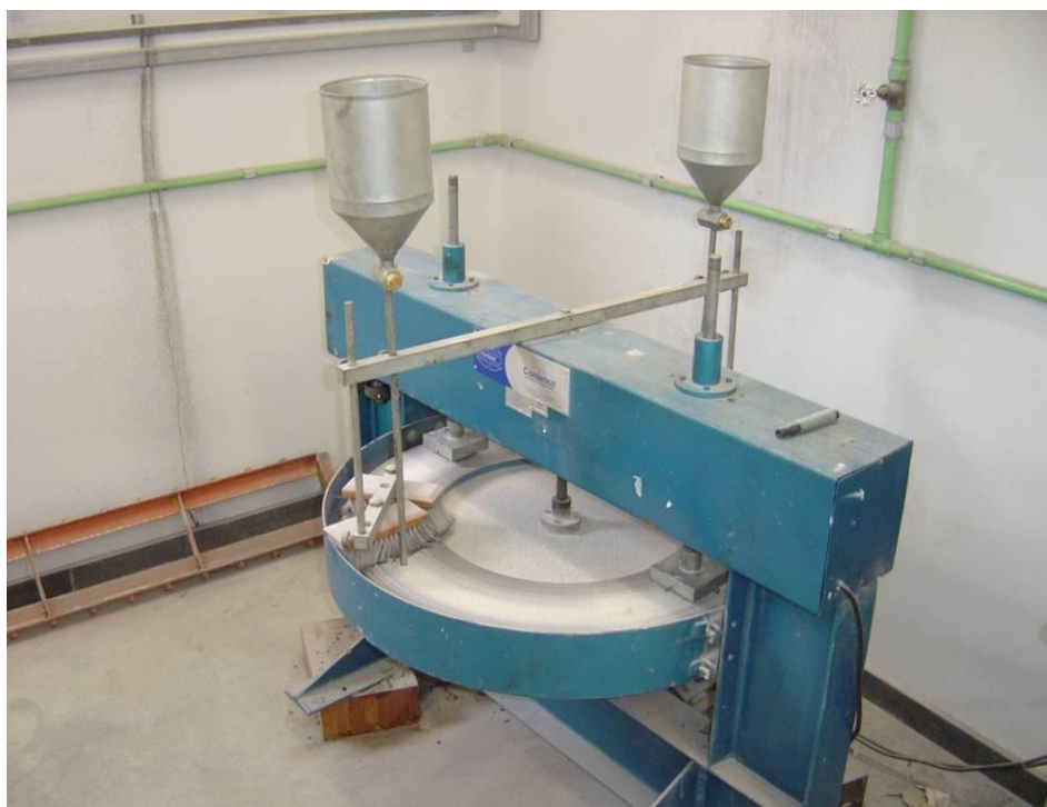
Figura 2.32 - Máquina utilizada para o ensaio de Abrasão Amsler
