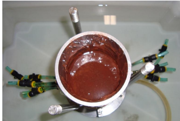
Figura 3.27 - Montagem do corpo de prova
