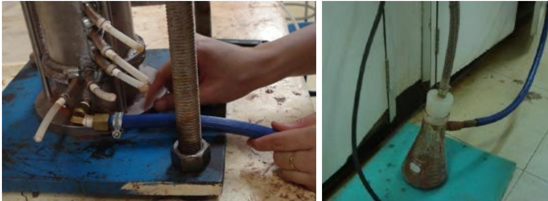
Figura 2.31 - Ensaio especial de redução de umidade em minério de ferro (FERREIRA, 2009)
