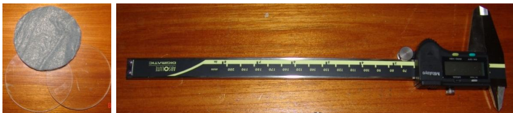
Figura 3.4 - Equipamentos utilizados para obtenção da espessura do geossintético
