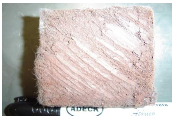
Figura 3.9 - Acúmulo de minério no geotêxtil
