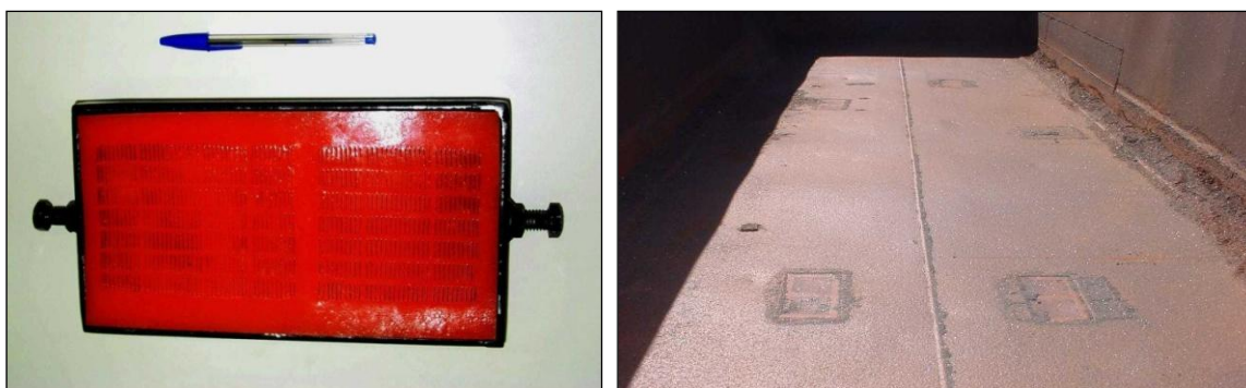
Figura 2.11 - Dreno de poliuretano utilizado pela VALE S.A. para drenagem dos vagões (VALE, 2003)
