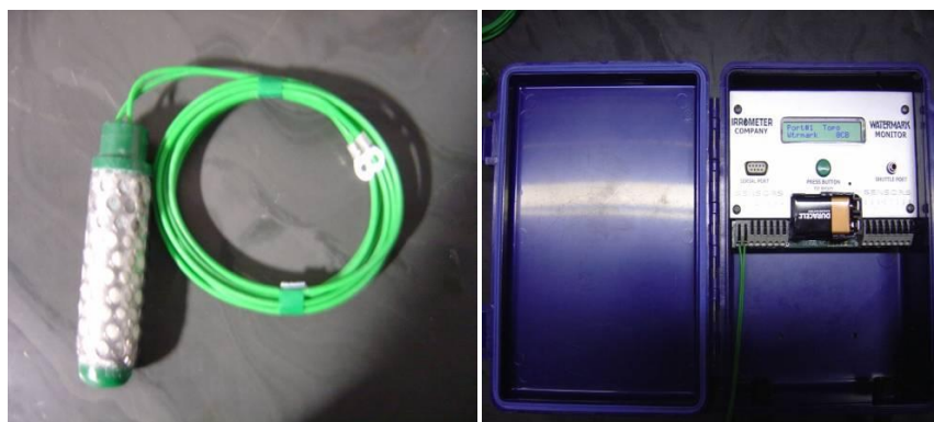
Figura 3.17 - Tensiômetros Watermark ® com sistema de aquisição de dados
