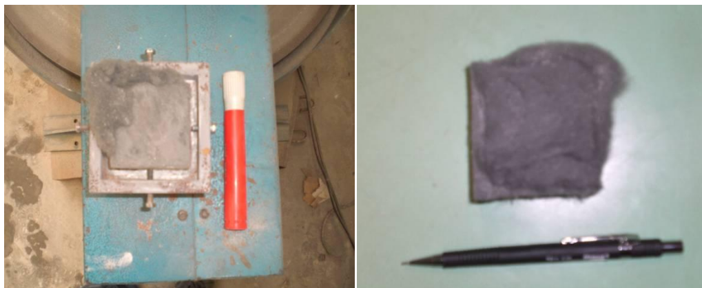
Figura 4.20 - Geotêxtil após 70 giros
