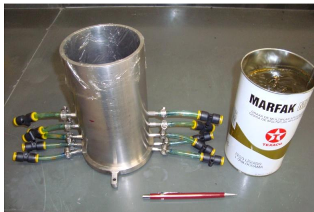
Figura 3.26 - Lubrificação com graxa automotiva e filme plástico
