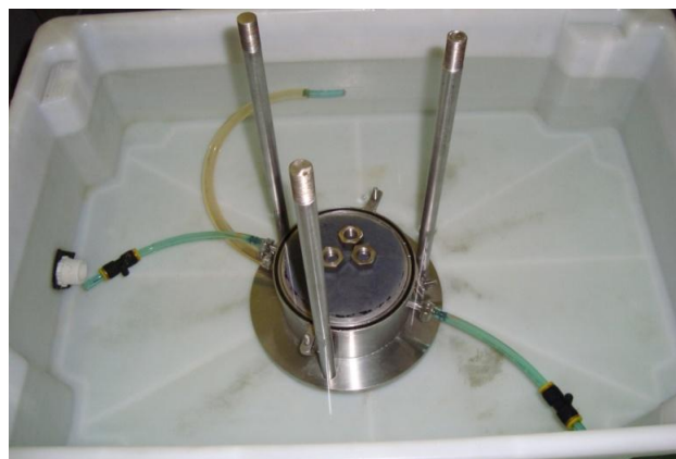
Figura 3.25 - Montagem da parte inferior do permeâmetro
