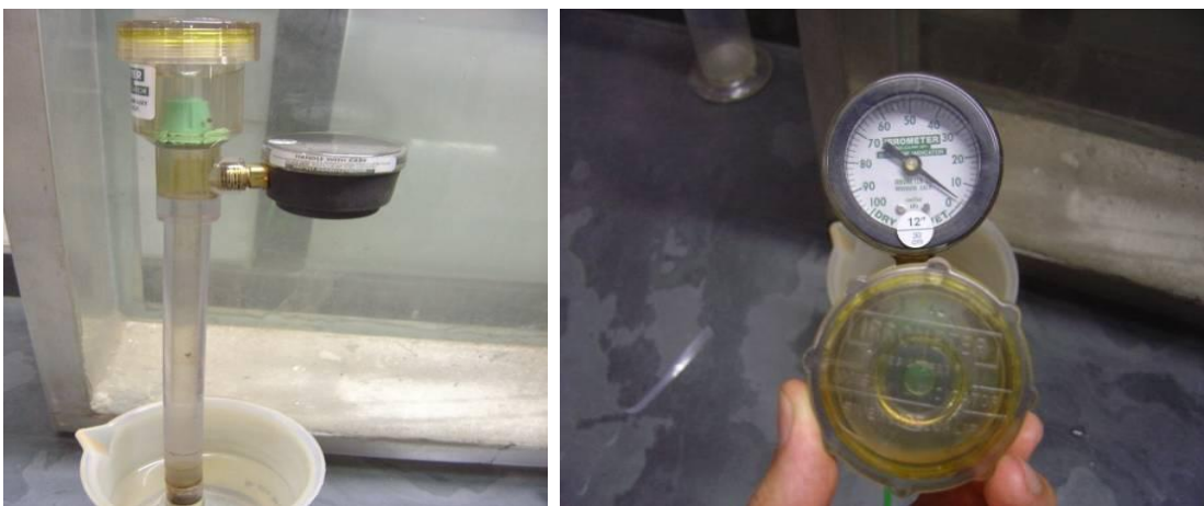
Figura 3.23 - Tensiômetros de vácuo com cápsula cerâmica
