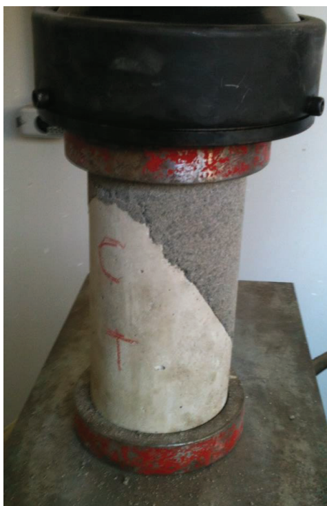
Figura 7-14 - Cisalhamento inclinado - Mcc - rompimento
