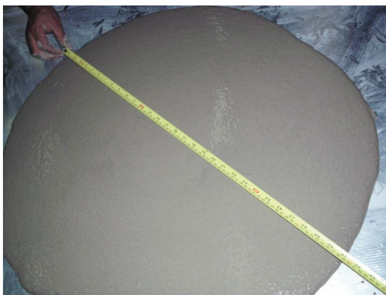
Figura 6-1 - Medida do Slump Flow test
