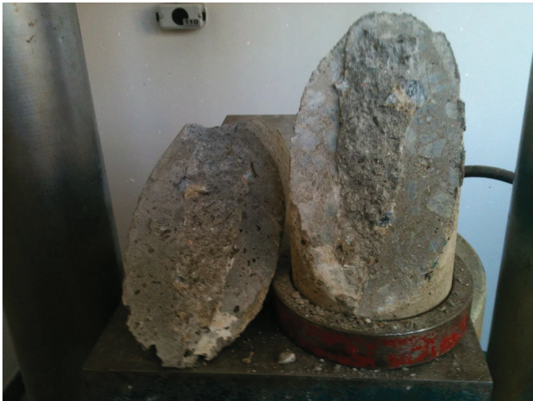
Figura 7-10—Cisalhamento inclinado - Mn - interface do rompimento
