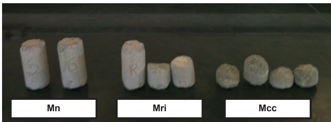
Figura 6-18 - Corpos de prova após o ensaio de abrasão
