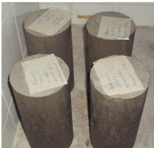
Figura 6-4 - Cura úmida dos corpos de prova
