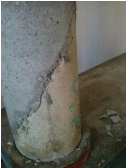
Figura 7-8—Cisalhamento inclinado - Mn
