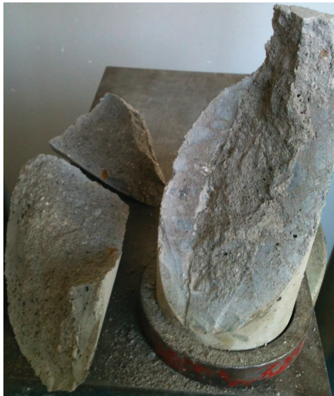
Figura 7-13 - Cisalhamento inclinado -Mri - interface do rompimento
