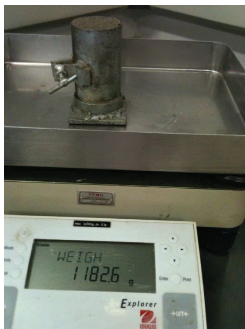
Figura 6-11 - Massa específica fresca - peso do molde preenchido
