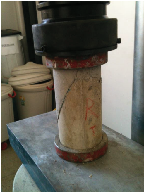
Figura 7-11 - Cisalhamento inclinado - Mri - rompimento
