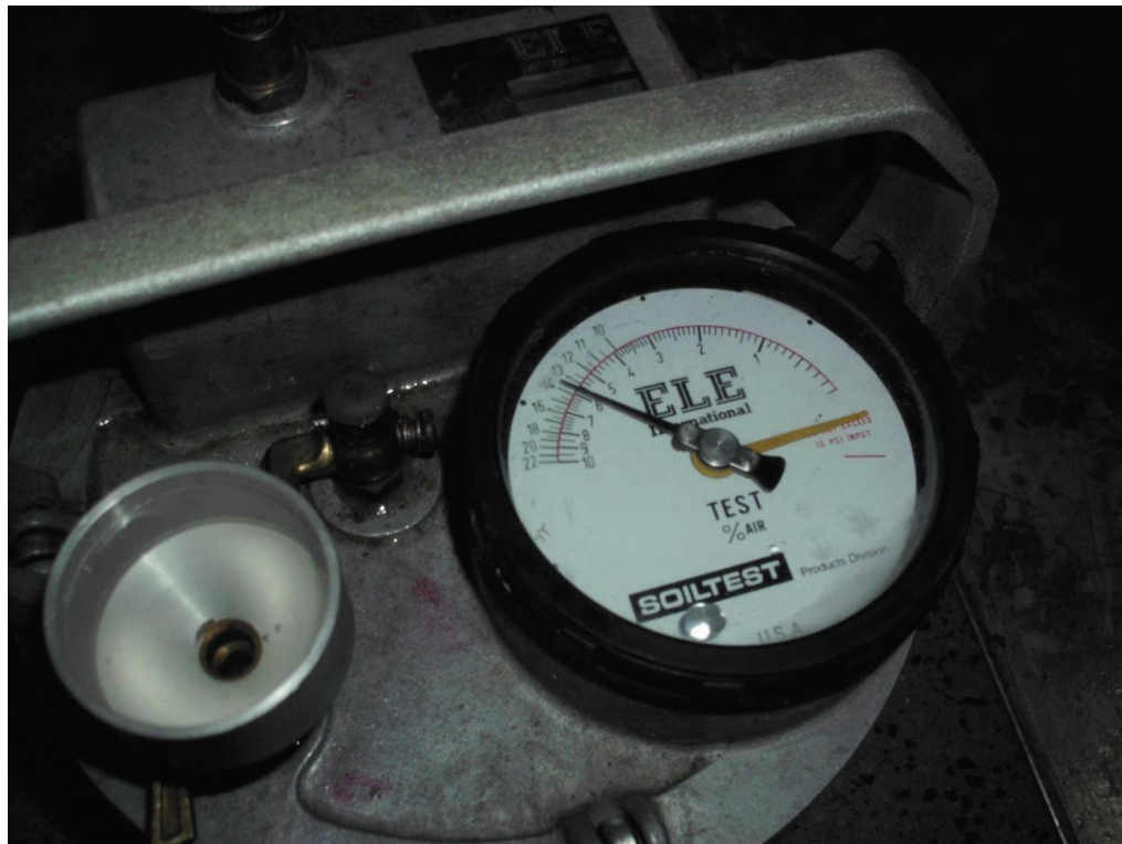
Figura 6-2 - Equipamento utilizado no ensaio de ar incorporado
