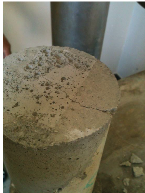
Figura 7-9 - Cisalhamento inclinado - Mn - rompimento
