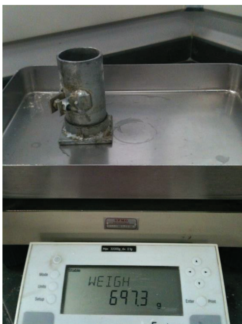
Figura 6-10 - Massa específica fresca - peso do molde seco
