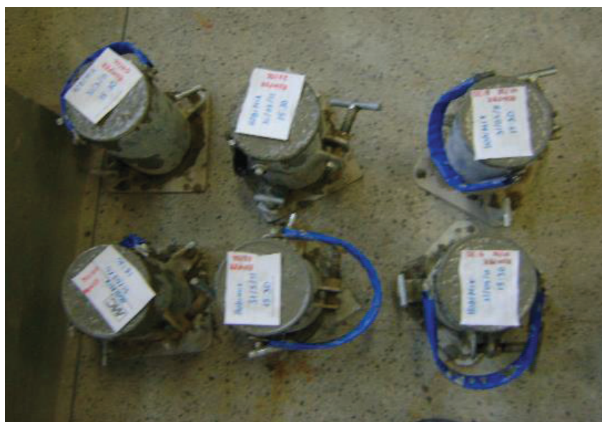
Figura 6-3 - Moldagem e identificação dos corpos de prova
