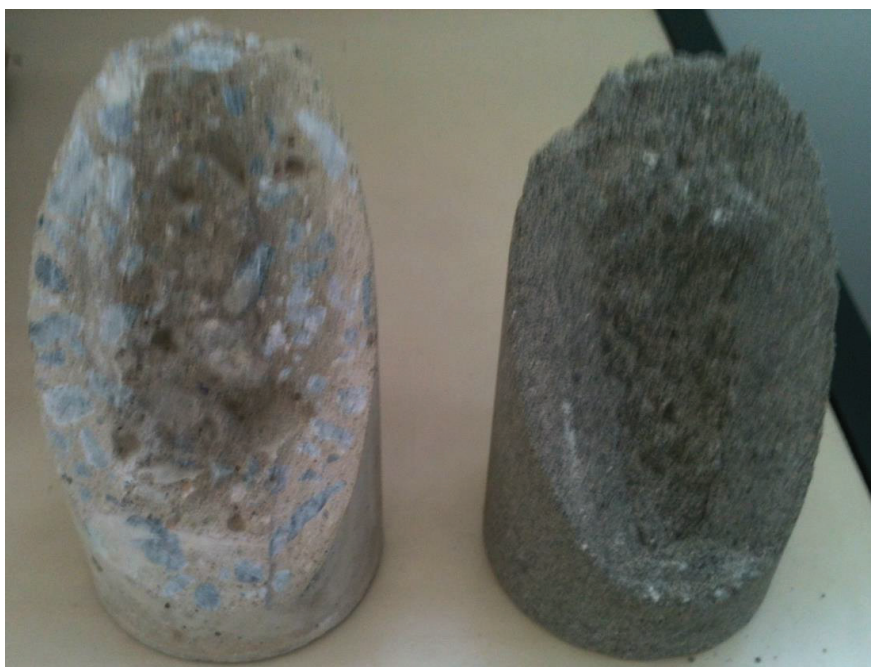
Figura 7-15 - Cisalhamento inclinado - Mcc - interface do rompimento
