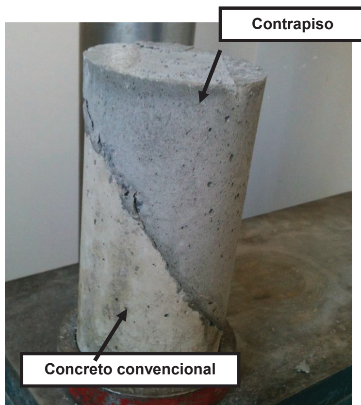
Figura 6-23 - Detalhe do corpo de prova preparado para avaliar o cisalhamento inclinado
