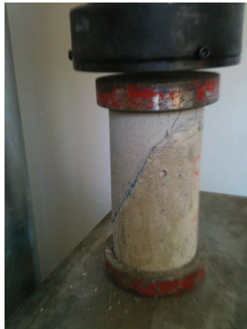
Figura 7-12 - Cisalhamento inclinado - Mri - rompimento e fissuras
