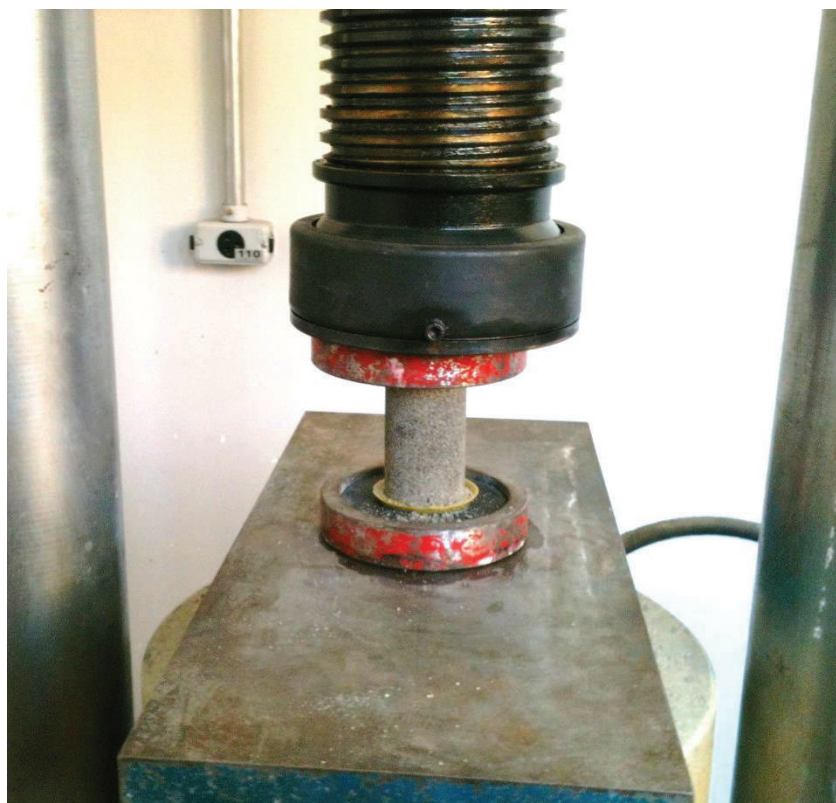
Figura 6-15 - Rompimento dos corpos de prova 5 x10 cm
