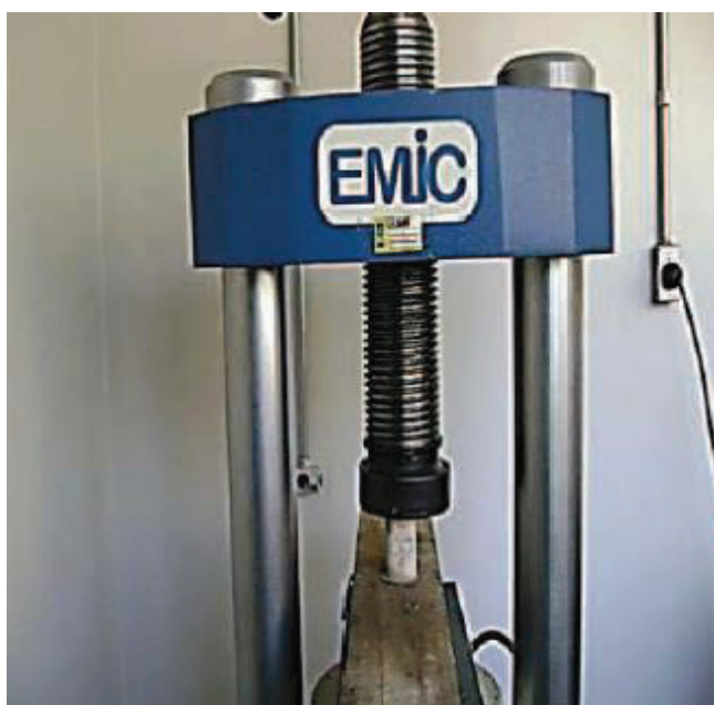
Figura 6-5 - Prensa EMIC para ensaios de resistência à compressão axial
