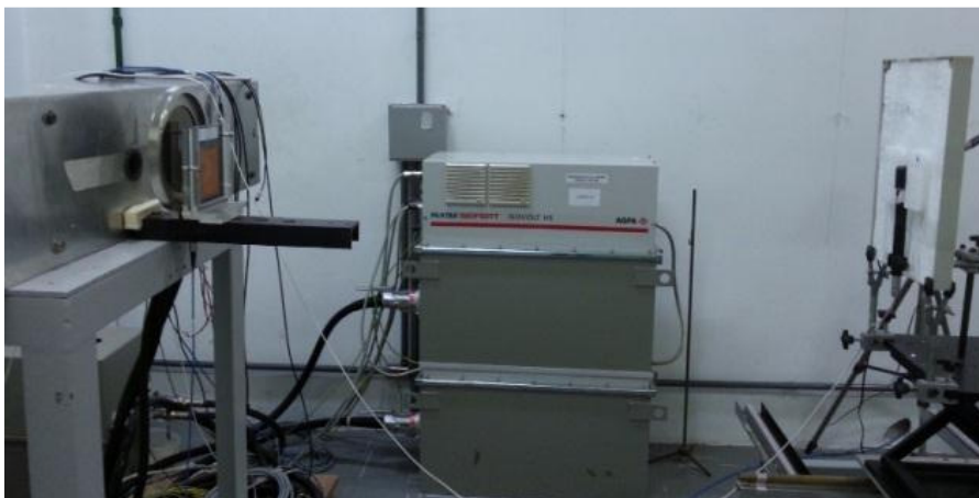
Figura 40. Posicionamento da câmara de ionização e dosímetros TL na irradiação.
