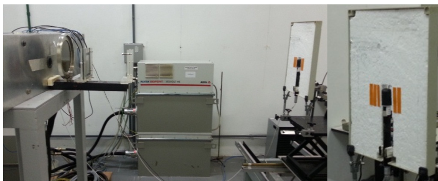
Figura 41. Posicionamento da câmara de ionização e filmes radiocrômicos na irradiação.
