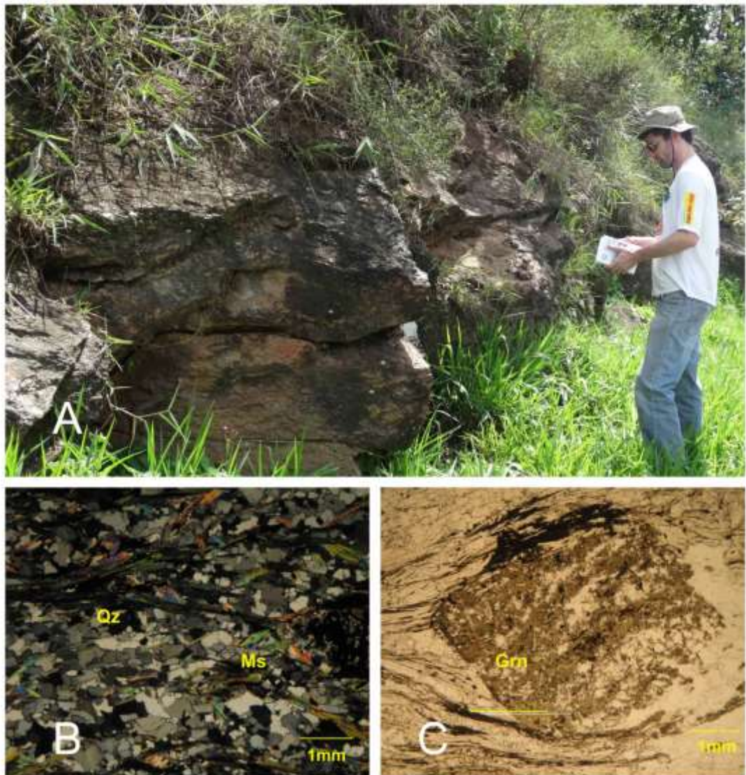
Figura 13. Características em campo e lâmina delgada da amostra. A) Afloramento de beira de estrada do mica-quartzo xisto. B) Fotomicrografia sob polarizadores cruzados de lâmina do xisto rico em quartzo e foliação formada por muscovita. C) Fotomicrografia sob polarizadores descruzados mostrando profiroblasto obliterado de granada rotacionado na foliação.
