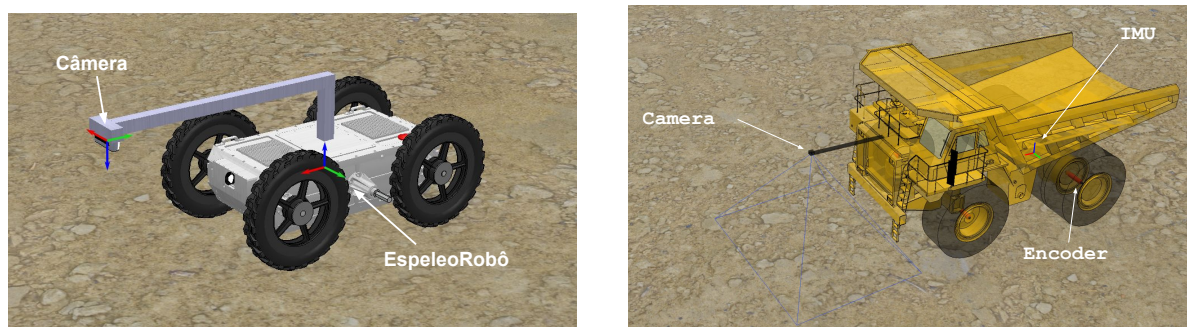
(a) Configuração do EspeleoRobô com câmera direcionada para o chão. (b) Configuração do caminhão CAT793F com câmera direcionada para o chão.
