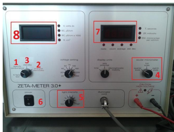
Figura 9 – Painel de controles e ajustes do Zeta Meter.
