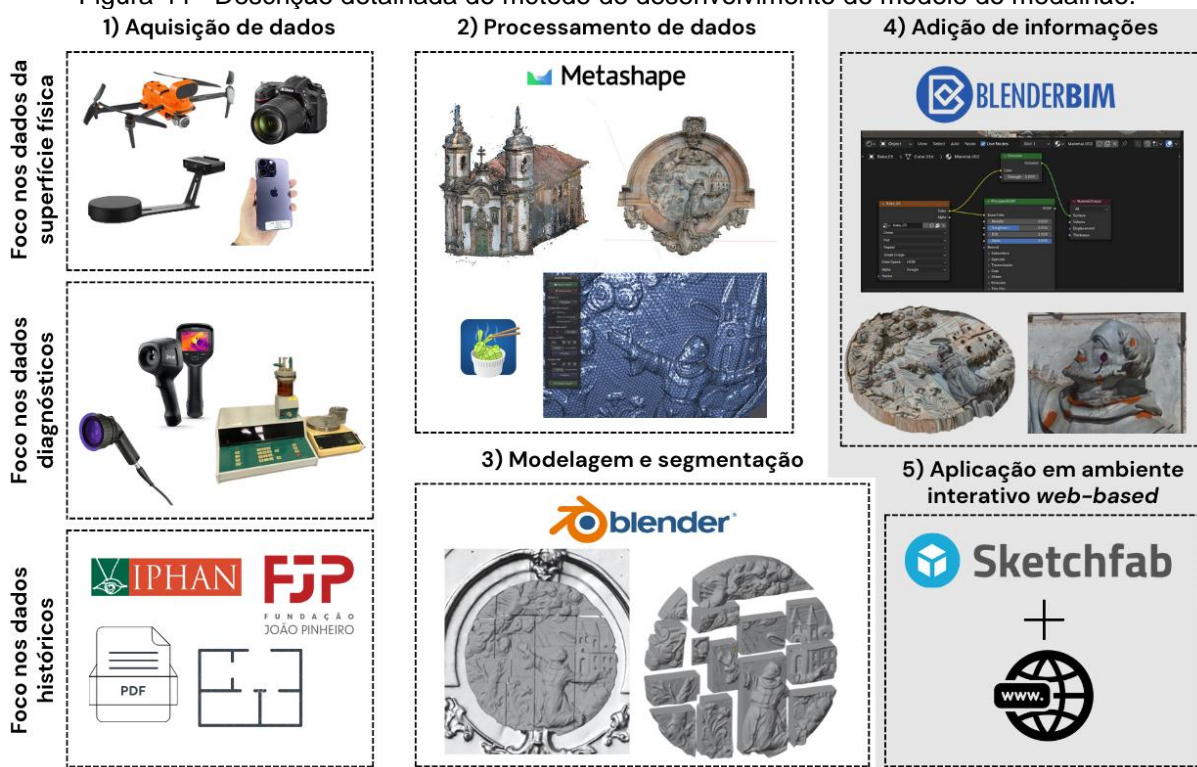
Figura 44 - Descrição detalhada do método de desenvolvimento do modelo do medalhão.
