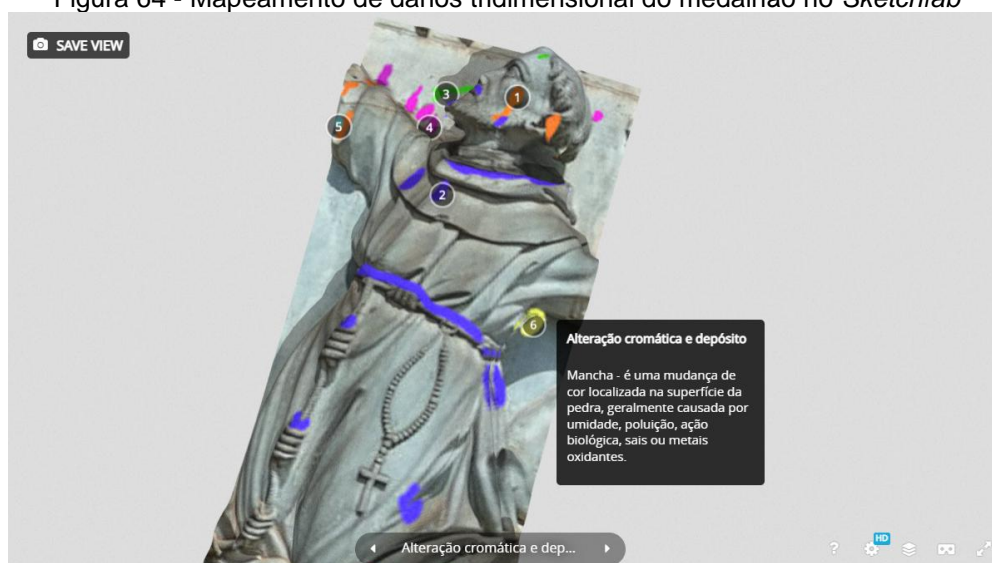
Figura 64 - Mapeamento de danos tridimensional do medalhão no Sketchfab
