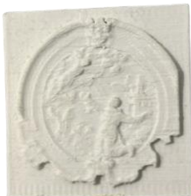
Figura 52 - Impressão 3D de teste inicial para comprovar o fechamento da malha do medalhão.
