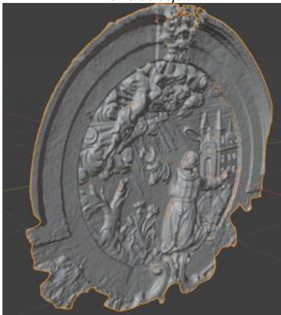
Figura 48 - Falhas na malha do objeto 3D, especialmente onde está grifado de laranja na parte interna do objeto
