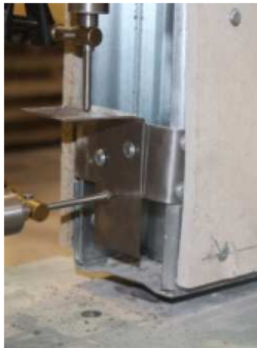
Figura 2.15 - Detalhe da posição dos medidores de deslocamento (Fonte: Baldassino et al. , 2014)
