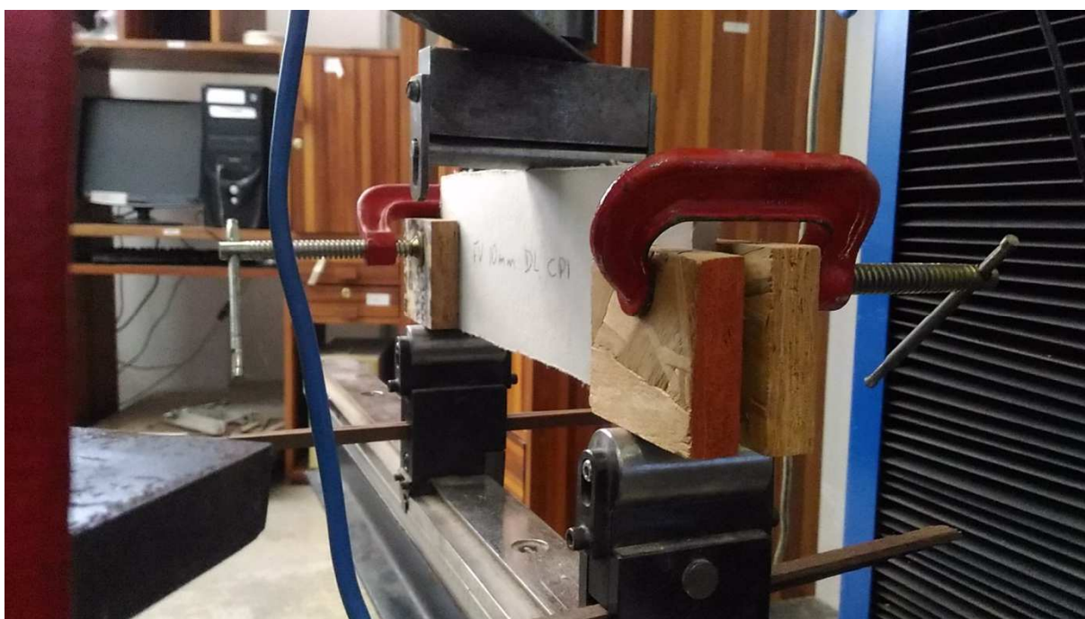
Figura 3.8 - Montagem do ensaio de resistência à tração na flexão na posição vertical.
