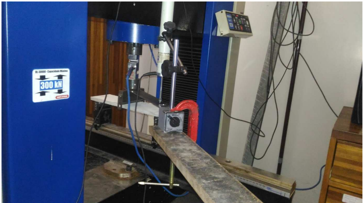
Figura 3.3 - Montagem do ensaio de resistência à tração na flexão.
