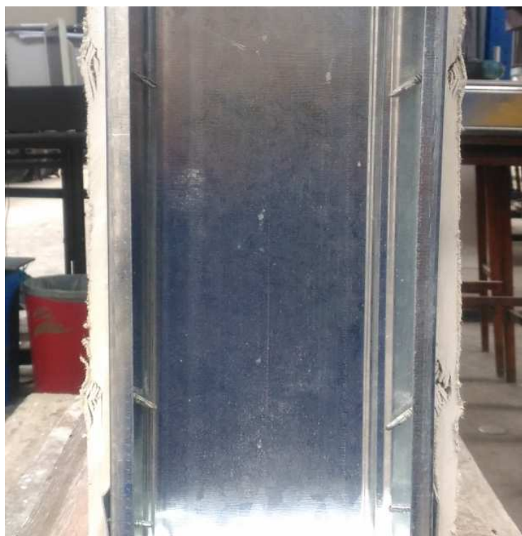
Figura 5.12 - Detalhe da rotação dos parafusos durante e após ensaio.
