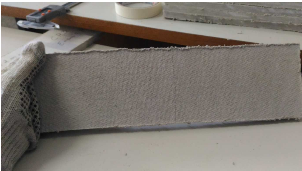
Figura 3.5 - Vista inferior da placa cimentícia rompida após o ensaio de flexão três pontos na posição horizontal.
