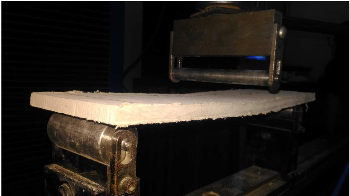
Figura 3.4 - Placa cimentícia com deformação plástica adquirida após o ensaio.
