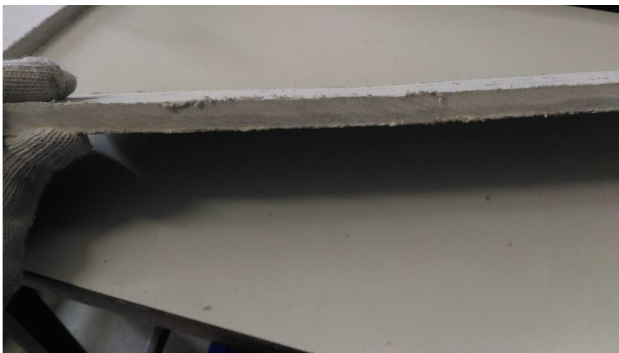
Figura 3.6 - Vista lateral da placa cimentícia rompida após o ensaio de flexão três pontos na posição horizontal.
