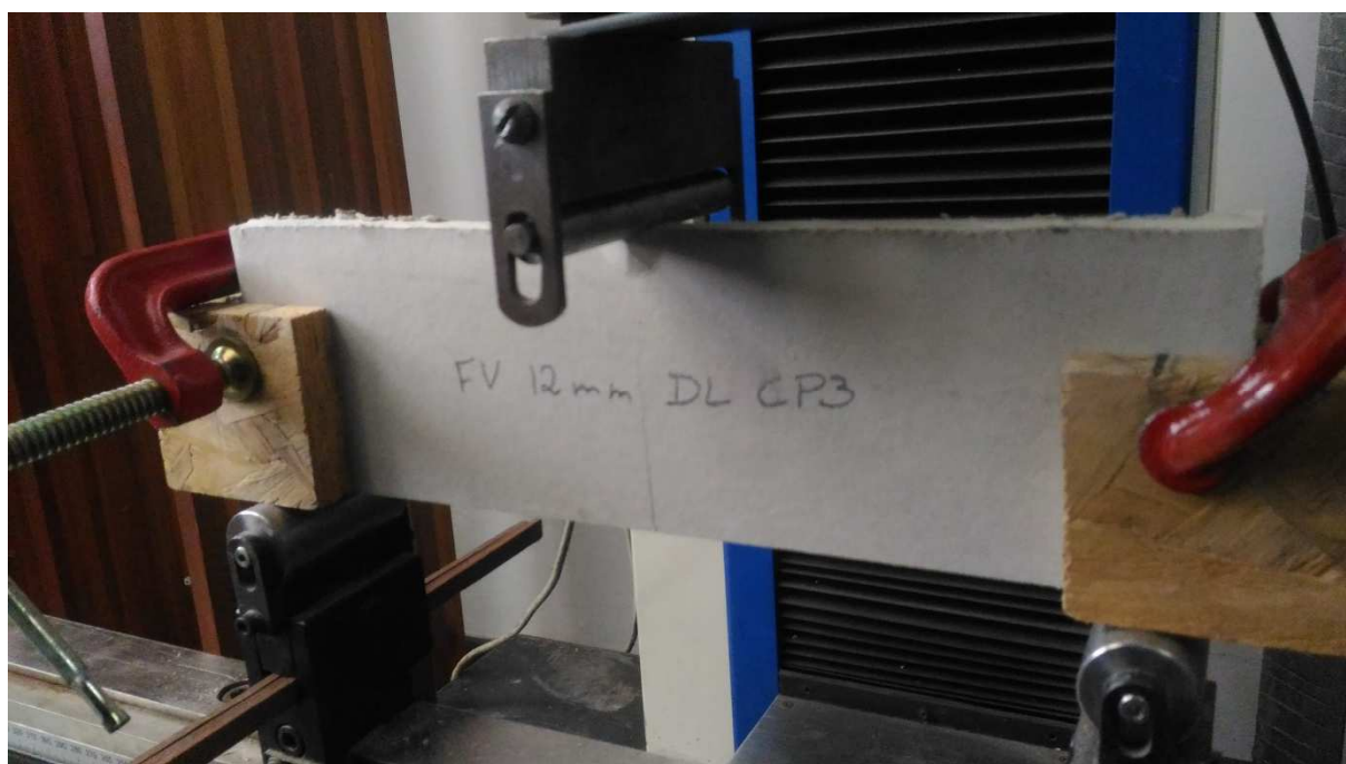
Figura 3.10 - Vista lateral da placa cimentícia rompida após o ensaio de resistência a tração na flexão na posição vertical.
