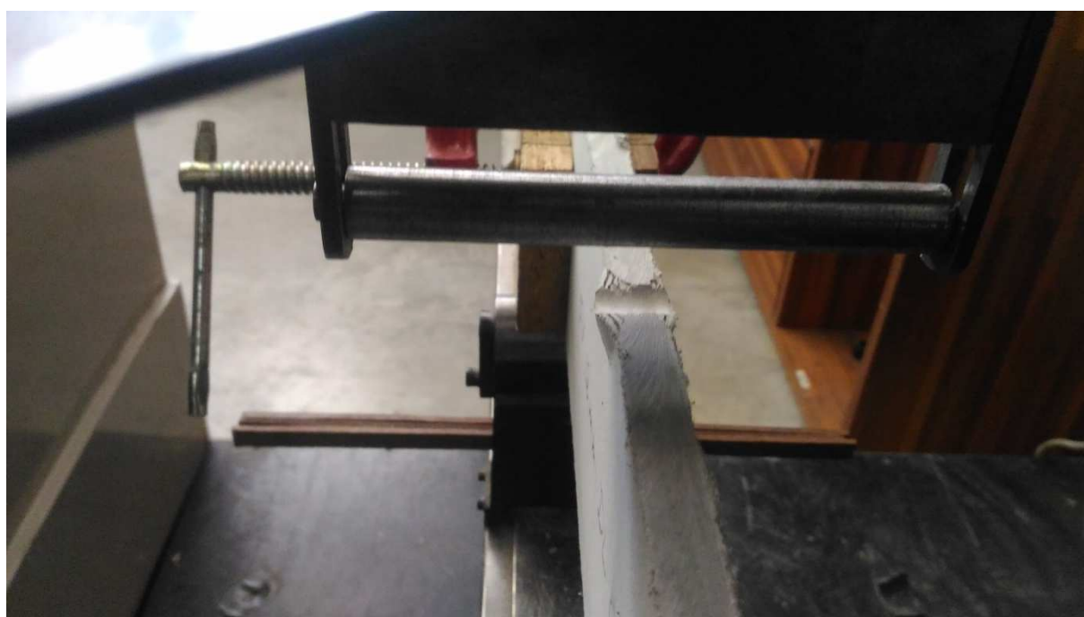
Figura 3.10 - Vista lateral da placa cimentícia rompida após o ensaio de resistência a tração na flexão na posição vertical.
