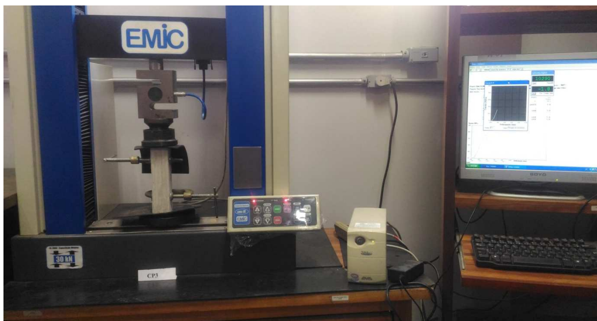
Figura 4.3 - Montagem do ensaio de compressão com aquisição de dados.
