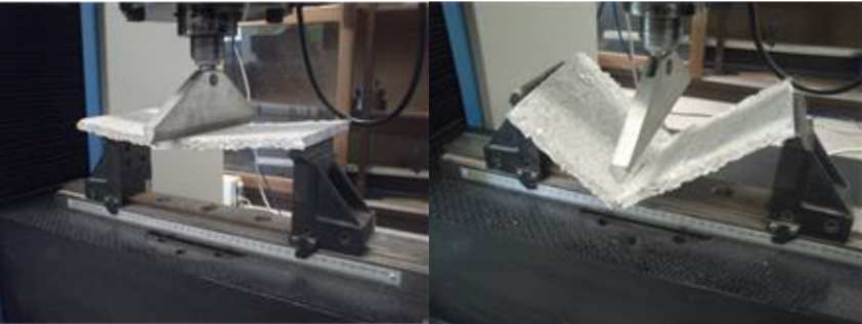
Figura 2.10 - Ensaio de flexão de placas cimentícias antes e após o rompimento (Fonte: Moura e Matos, 2015)
